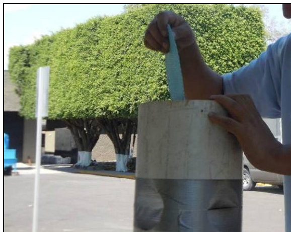
Figura 9. Colocación de las mallas metálicas en los tubos de P.V.C.
