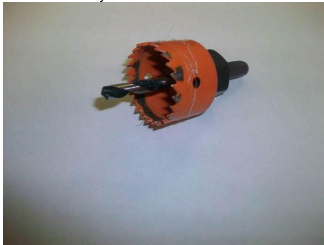
Figura 110. Broca con sacabocado utilizados.
