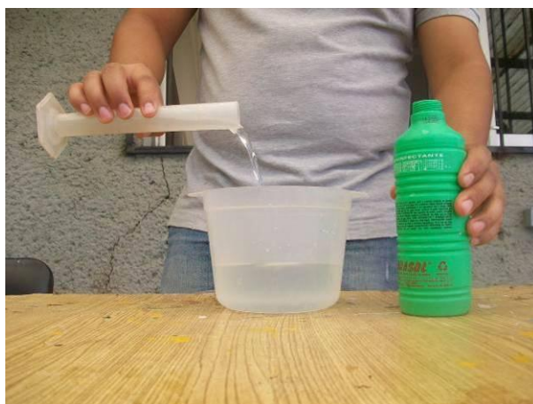
Figura 132. Utilización de cloro para la desinfección del dispositivo.
