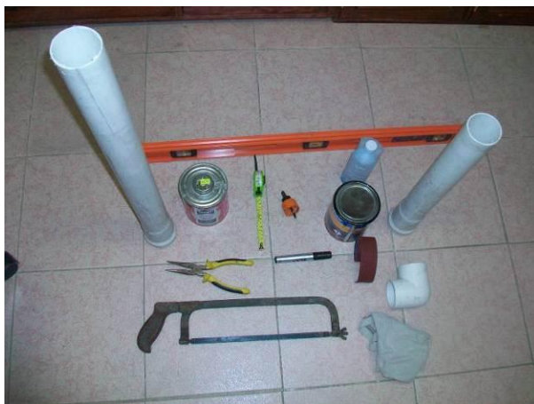
Figura 106. Materiales utilizados en el ensamble del sistema de conducción.
