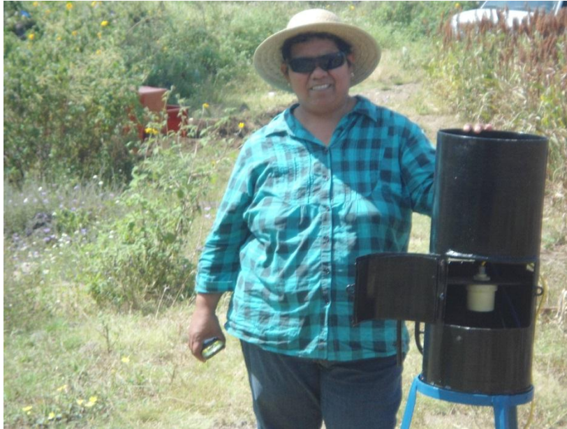
Figura 33. El prototipo de pluviógrafo terminado
