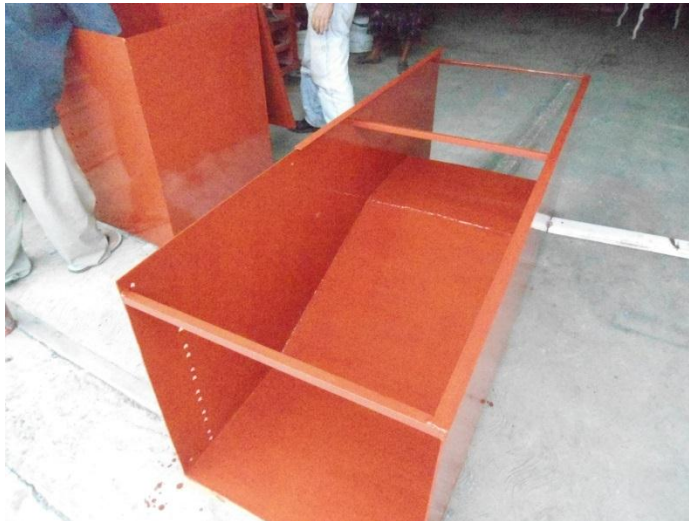
La canaleta de aforo terminada
