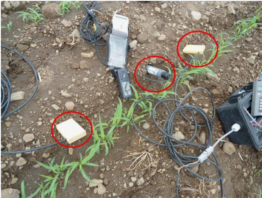
Fotografía 13. Monitoreo de humedad del suelo con equipo TDR.
