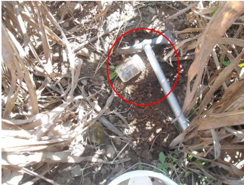
Fotografía 14. Muestreo de suelo para medir contenido de humedad.
