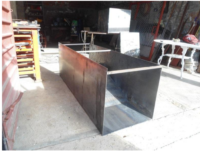
El cuerpo del aforador en construcción
