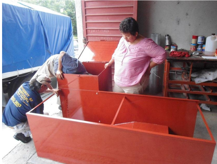
Ensamblando canaleta aforadora con caja de amortiguación
