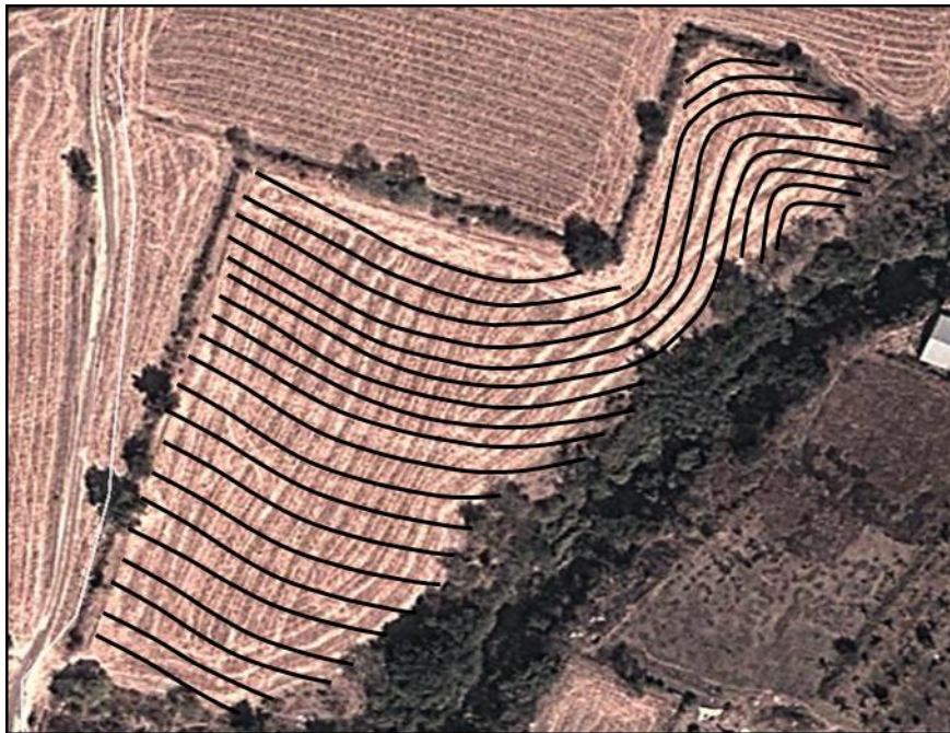
Figura 13. Trazo en gabinete del diseño hidrológico del terreno en parcela 1. Amayuca.
