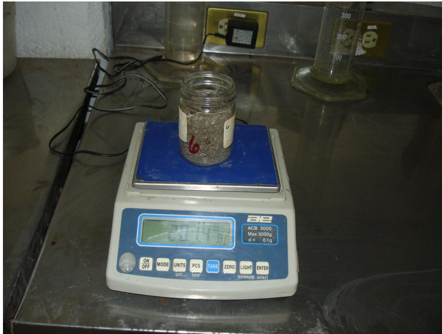
Fotografía 16. Pesaje de suelo para determinar contenido de humedad.
