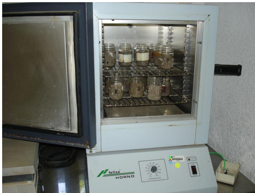
Fotografía 15. Secado de muestras de suelo en estufa.
