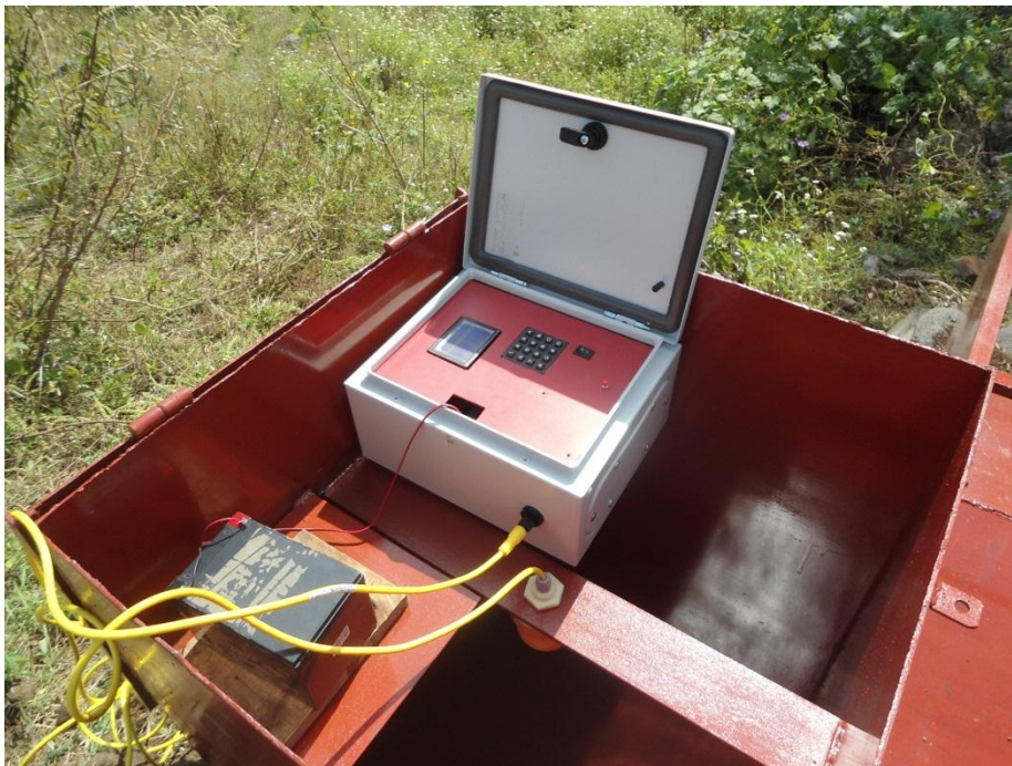
Acercamiento al equipo ultrasónico de medición del tirante
