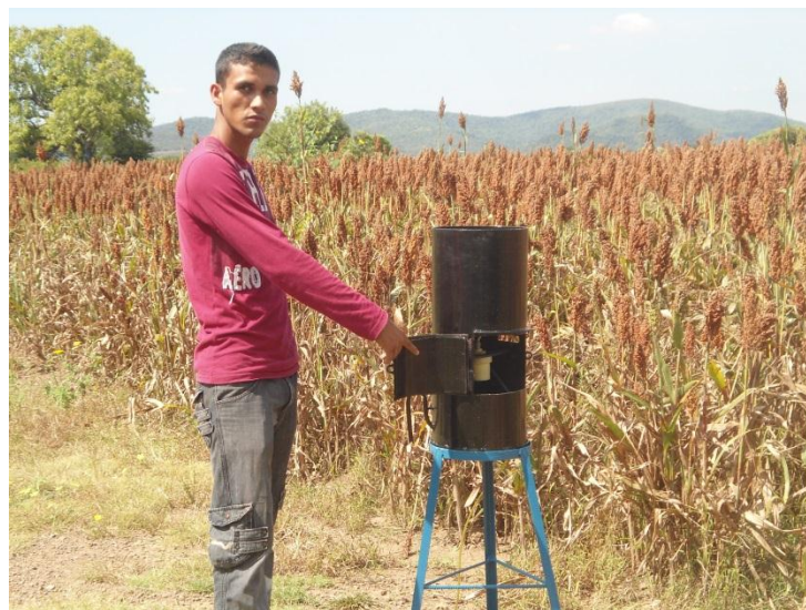
El pluviógrafo ya instalado en campo
