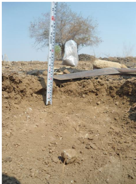
Fotografía 4. Muestreando profundidad del suelo sitio Tehuixtla.
