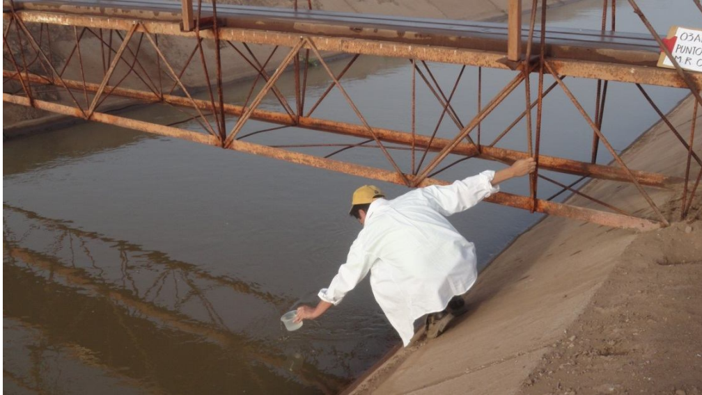
Ilustración 45. Muestreo y medición de la salinidad del agua de riego en el punto de control, Canal 3+300.
