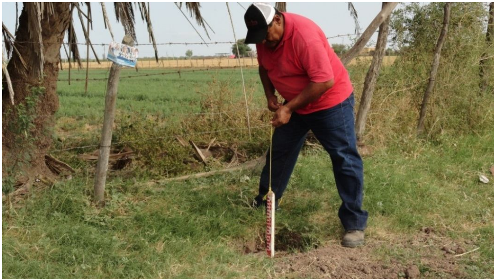
Ilustración 27. Monitorización de niveles freáticos
