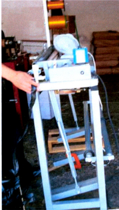
Figura 33 Máquina de termofusión para fabricación de cinta CRP.
