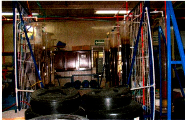
Figura 2 Arreglo experimental de los Biorreactores, para prueba de diferentes materiales de soporte en la planta piloto del IMTA
