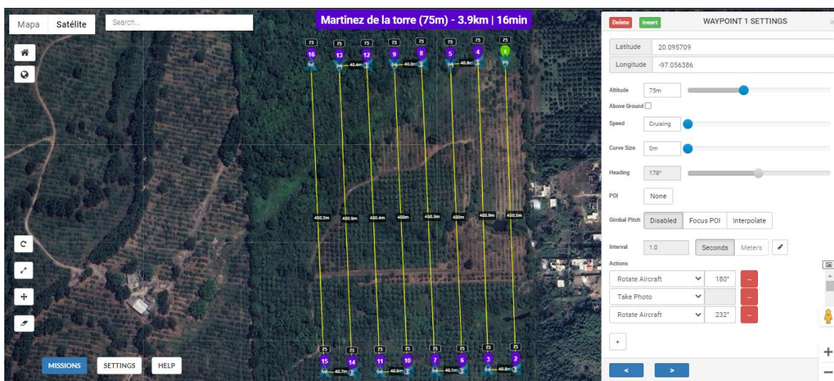
Figura 26. Programación de misión de vuelo en el software Litchi.
