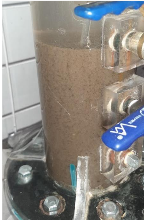
Figura 17. Lodo activado en el reactor aerobio 2.
