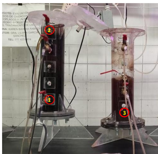
Figura 20. Tren de tratamiento biológico granular anaerobio/aerobio (1= Influyente; 2= Efluente medio-salida del reactor RAFA; 3= Efluente final - salida del reactor aerobio RBS).
