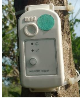
Figura 2. Sensor HOBO MX2301A operando en la huerta de lima Persa.
