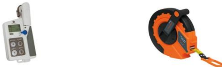
Figura 19. Sensor Konica Minolta SPAD 502 para estimación de clorofila en hojas (izquierda) y cinta métrica Truper utilizada para medir la altura y diámetro de copa de los árboles (derecha).
