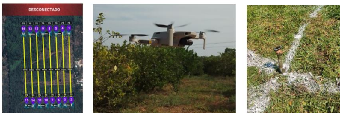
Figura 13. Plan de vuelo con software Litchi (izquierda) y DJI Mini SE finalizando misión (centro) y marca del punto (derecha).
