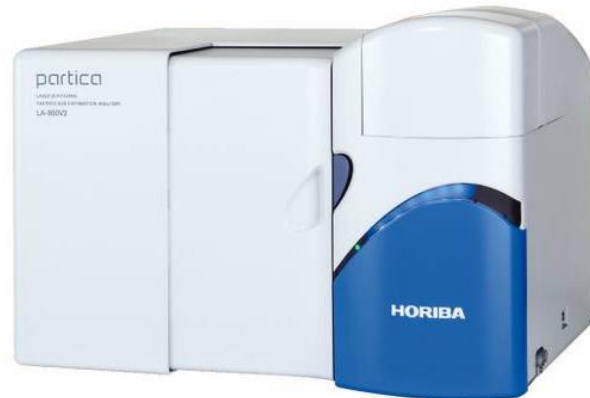
Figura 3-15 Análisis de tamaño de partículas por dispersión de luz láser Fuente: obtenido de la página oficial de HORIBA semiconductor
