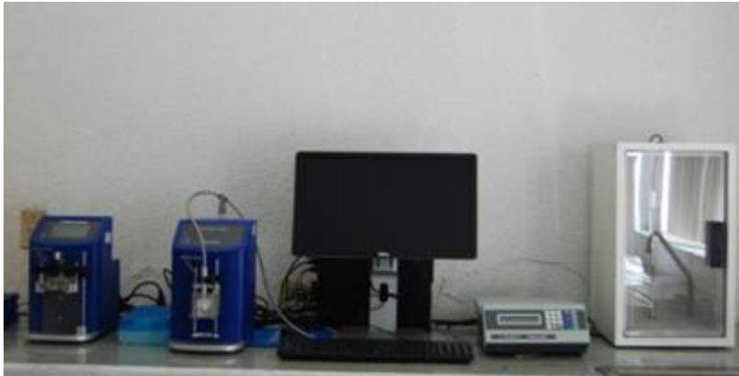
Figura 3-14 Equipo potencial zeta, Microtrac Zeta Check
