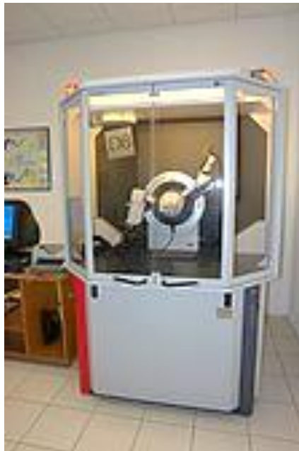
Figura 3-5 Difractómetro de Rayos-X - XRD Bruker D8 Advance
