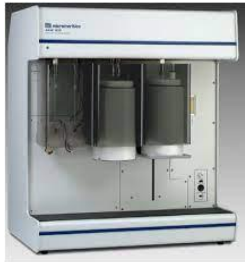
Figura 3-13 Analizador de Área Superficial y Porosimetría Acelerada Micromeritics ASAP 200
