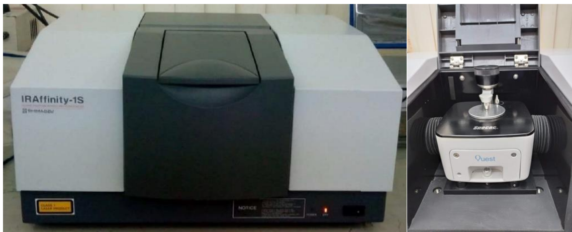
(a) (b) Figura 3-7 (a) Espectrofotómetro infrarrojo por transformada de Fourier - FTIR IR Shimadzu, (b) Accesorio ATR
