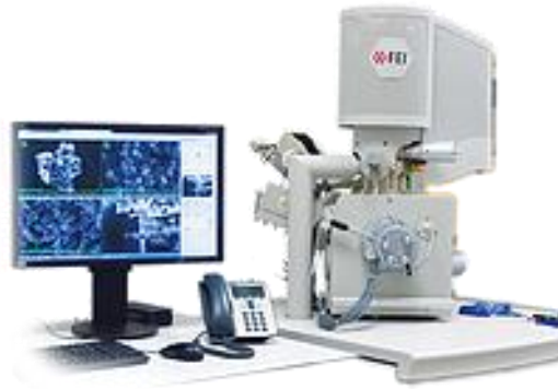
Figura 3-10 a) Microscopio electrónico de barrido acoplado a equipo de emisión de campo FEI - ESEM QUANTA FEG-250
