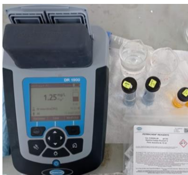
Figura 3-3 Espectrofotómetro portátil HACH DR/1900
