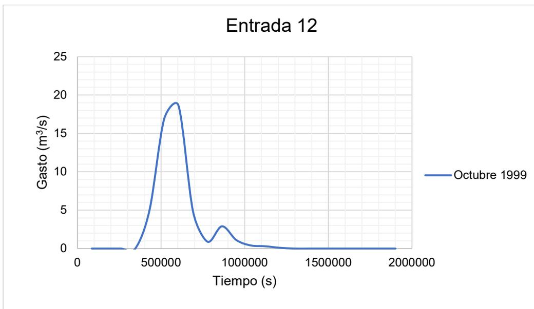
Figura 0.12. Hidrograma de entrada 12 para calibración del modelo hidráulico.
