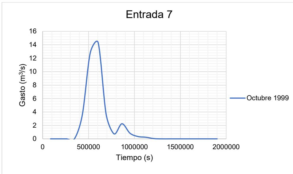
Figura 0.7. Hidrograma de entrada 7 para calibración del modelo hidráulico.
