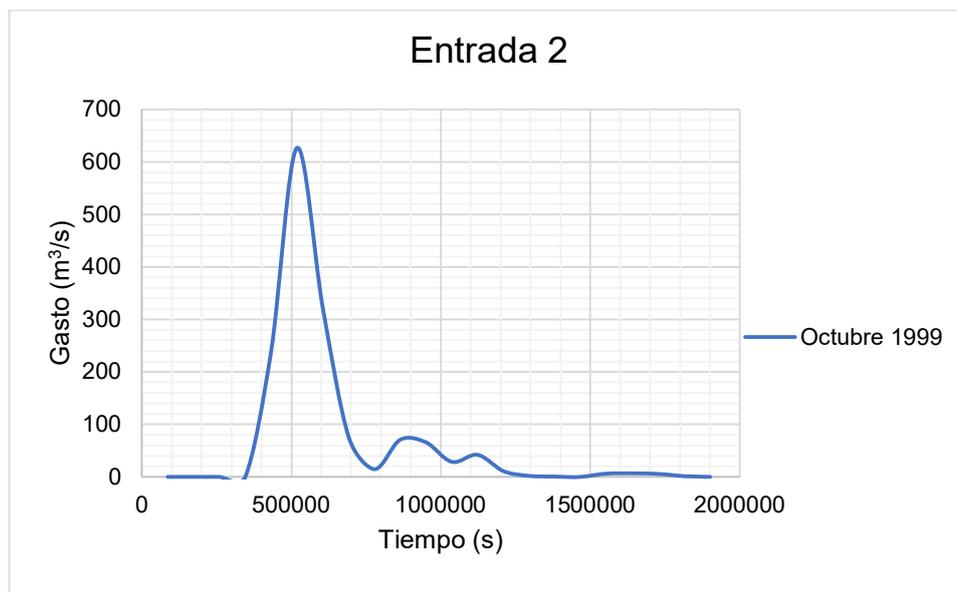
Figura 0.2. Hidrograma de entrada 2 para calibración del modelo hidráulico.
