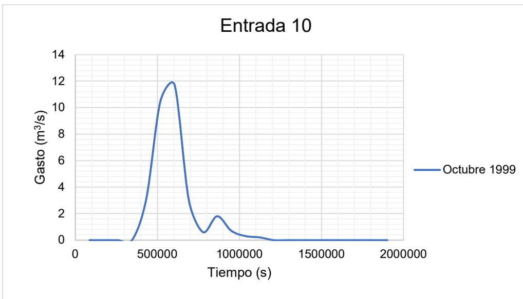
Figura 0.10. Hidrograma de entrada 10 para calibración del modelo hidráulico.
