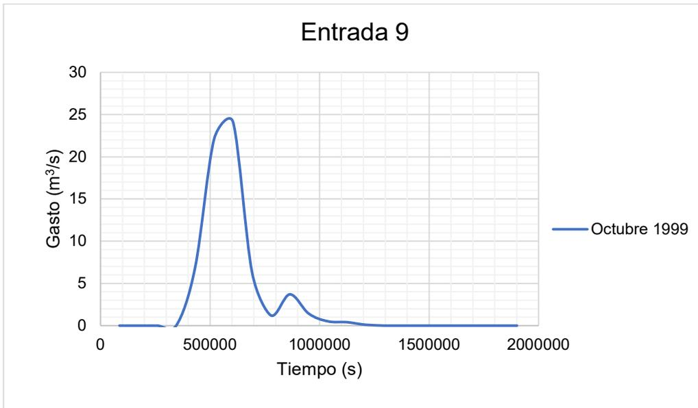
Figura 0.9. Hidrograma de entrada 9 para calibración del modelo hidráulico.
