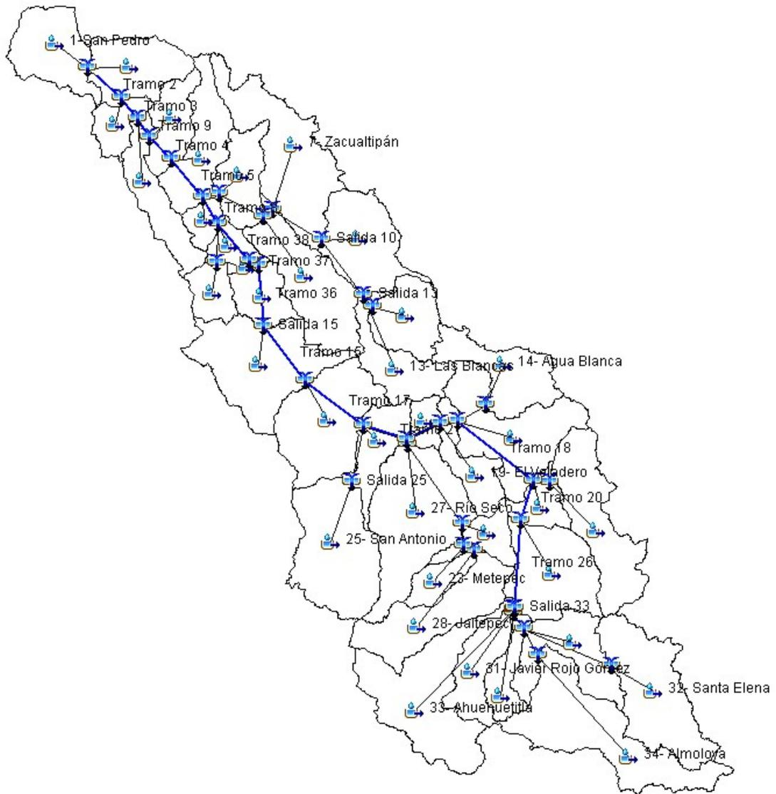
Figura 9.25. Modelo hidrológico completo en HEC-HMS.
