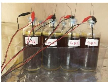
Figura 12. Operación de reactores anaerobios.
