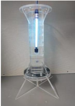
Figura 6. Reactor fotoquímico.
