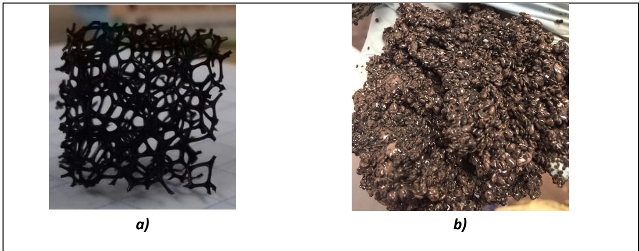
Figura 8. a) Cubo de poliuretano utilizado como medio de soporte para la biomasa en los reactores; b) Biomasa empleado en la investigación
