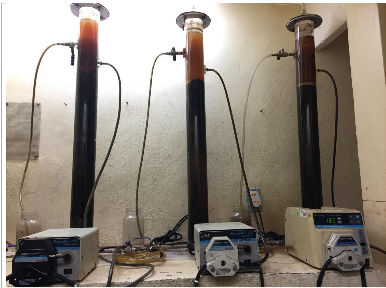
Figura 11. Filtros inoculados en etapa de estabilización
