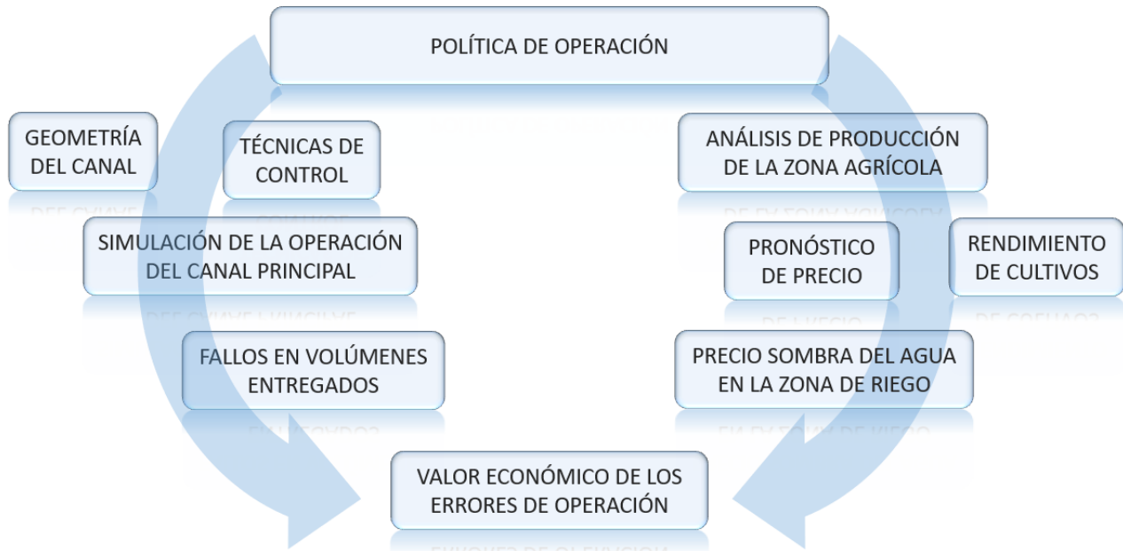
Figura 2. Mapa conceptual de operación integral de los canales de riego. Se muestra la interacción entre los aspectos técnicos de la operación de canales y los económicos de la zona agrícola. El valor económico de los errores en la operación es el reflejo de la eficiencia de las técnicas de control ante las condiciones específicas de mercado, rendimiento de cultivos y disponibilidad hídrica de una zona de cultivo.
