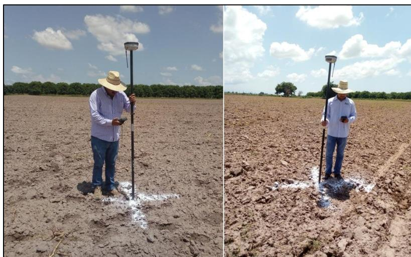
*Figura 31. Levantamiento de GCP con equipo GNSS RTK*
