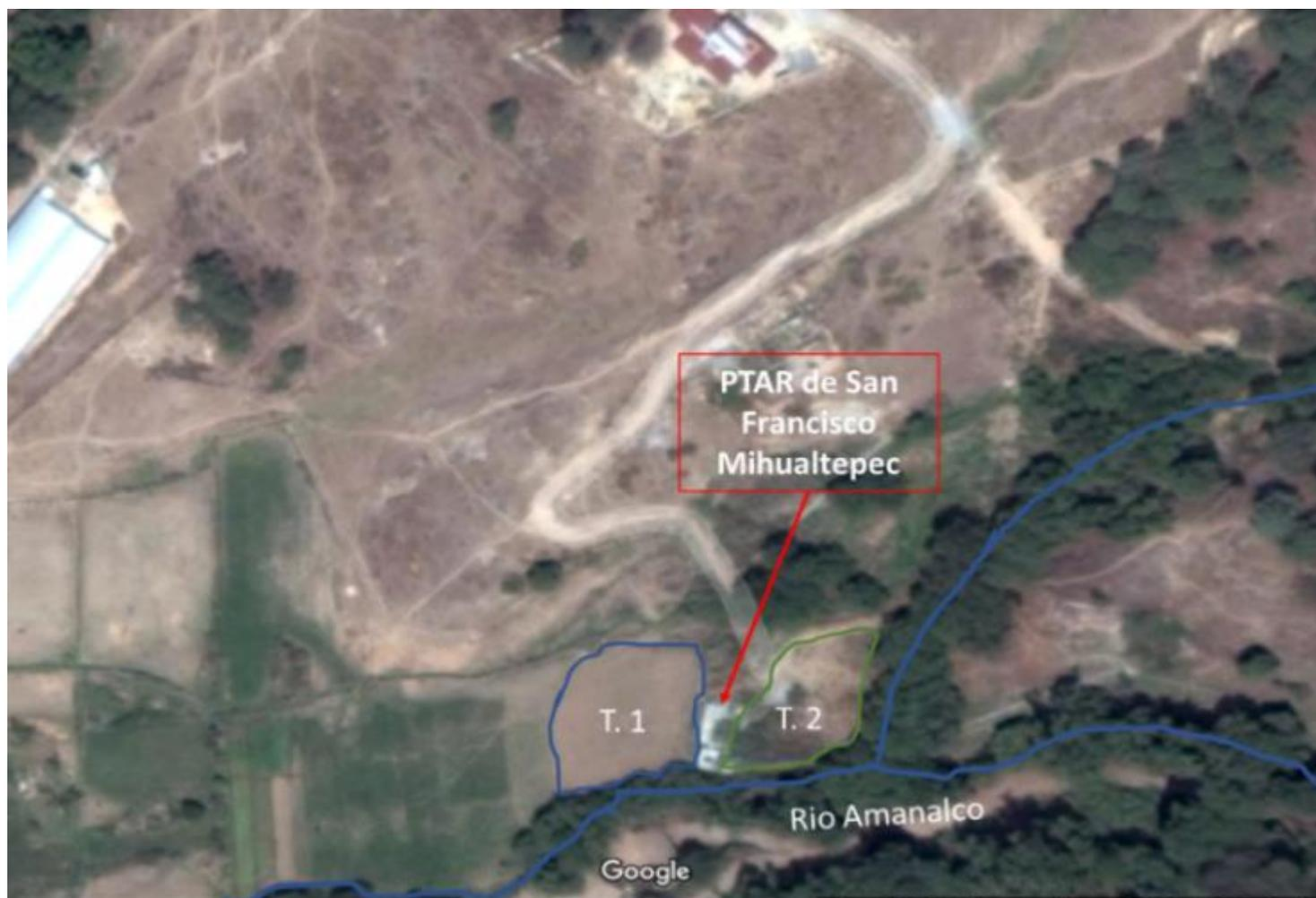
Figura 5.2.2.3.9- Terrenos aptos para la instalación de un humedal artificial para tratar agua residual de la localidad de San Francisco Mihualtepec.
