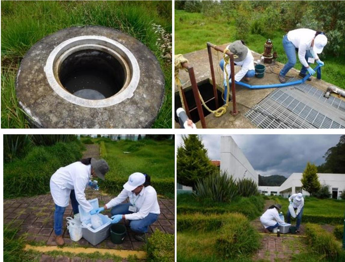
Foto 5.6.2.2.1- Muestreo, registro de parámetros de campo y preservación de muestras de la descarga de aguas residuales del Hospital Rural IMSS, Amanalco, Estado de México
