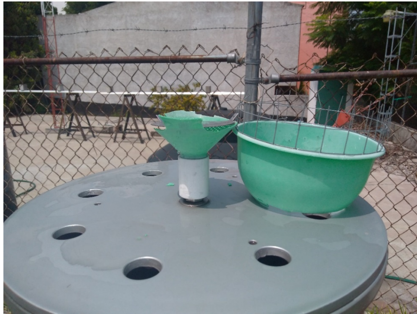
Figura 12 Embudo dañado debido a la exposición en climas cálidos estación Tetelco CDMX
