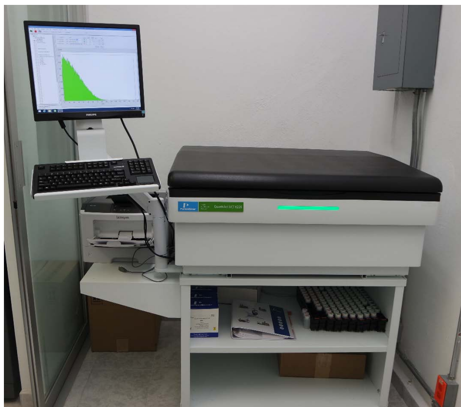
Figura 38 Contador de centelleo líquido Perkin Elmer Quantulus GCT 6220 instalado en el IMTA
