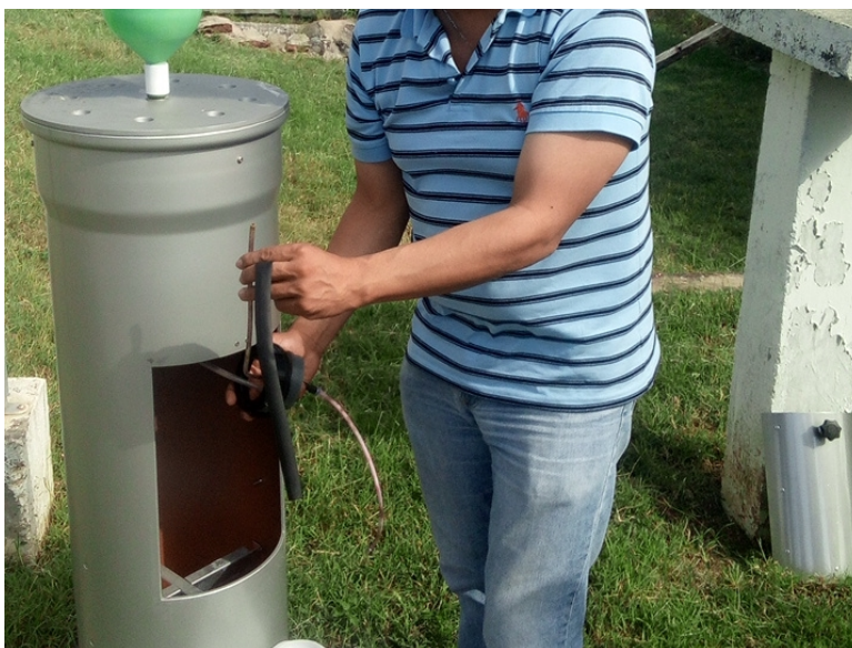
Figura 17 Manguera con suciedad acumulada
