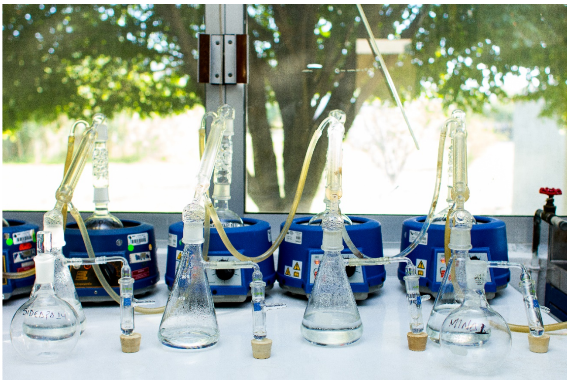
Figura 36 Proceso de destilación primaria realizado en el laboratorio de tritio ambiental del IMTA
