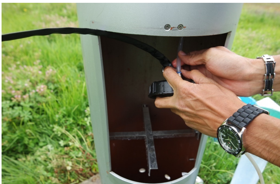
Figura 15 Localización de la manguera de purga
