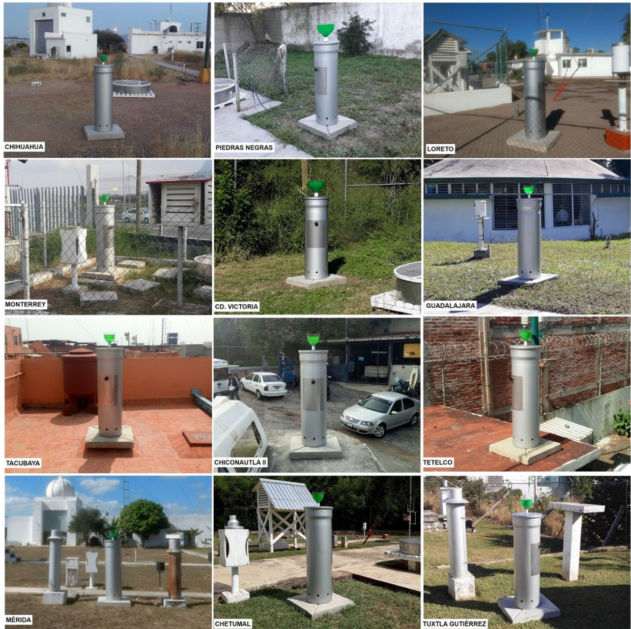
Figura 4 Continuación. Colectores de agua de lluvia de las estaciones de la RENIP
