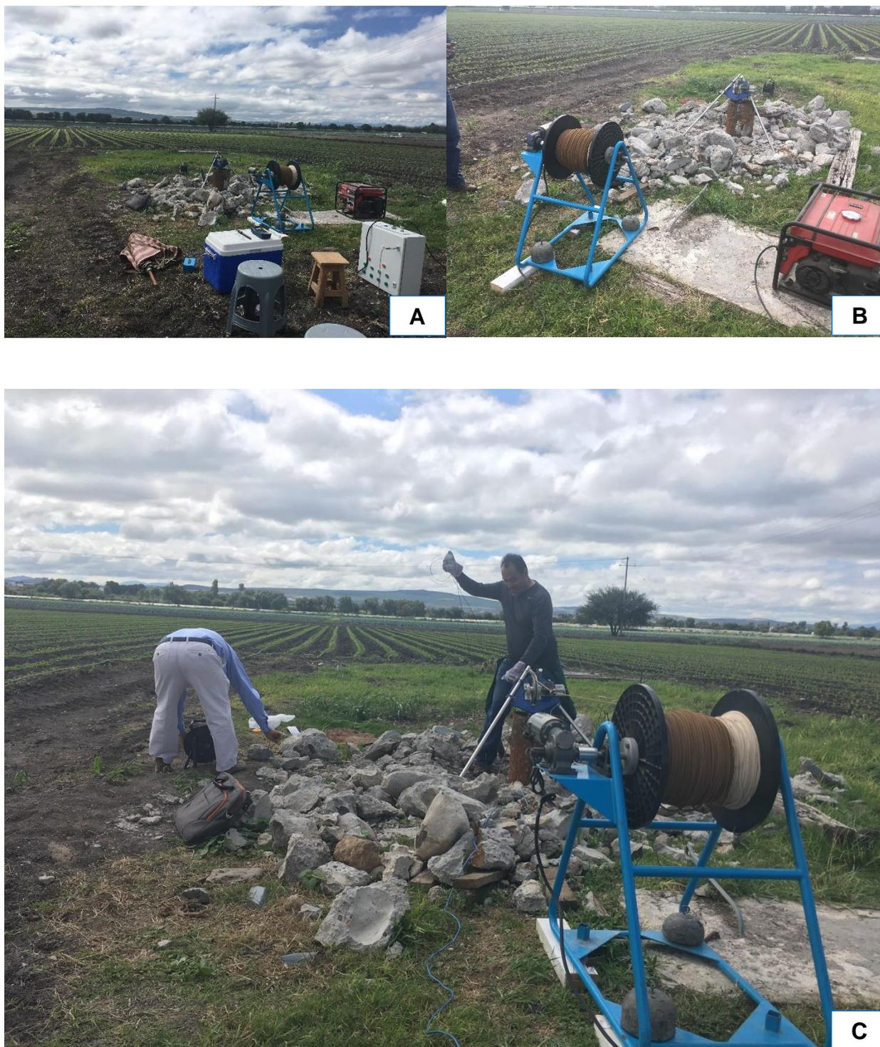
**Figura 23. A)** Equipo de medición. **B)** Pozo el Castillo. **C)** Medición del nivel piezométrico mediante una sonda.
