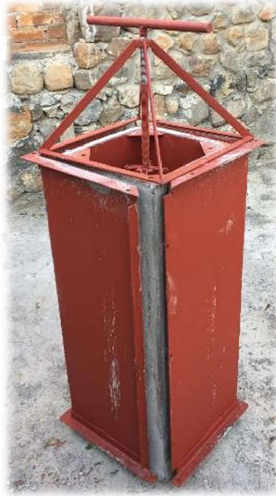
Ilustración 53: Retiro de la estructura de concreto del molde.
