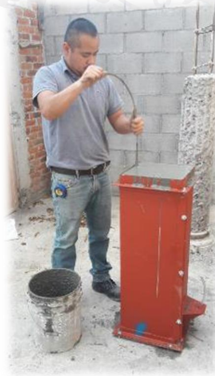
Ilustración 52: Colado del molde del filtro de flujo lento.
