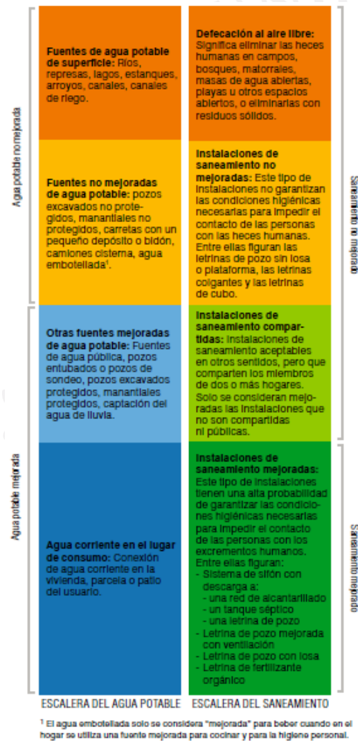
Ilustración 6: Escalera del agua potable y saneamiento del PCM.
