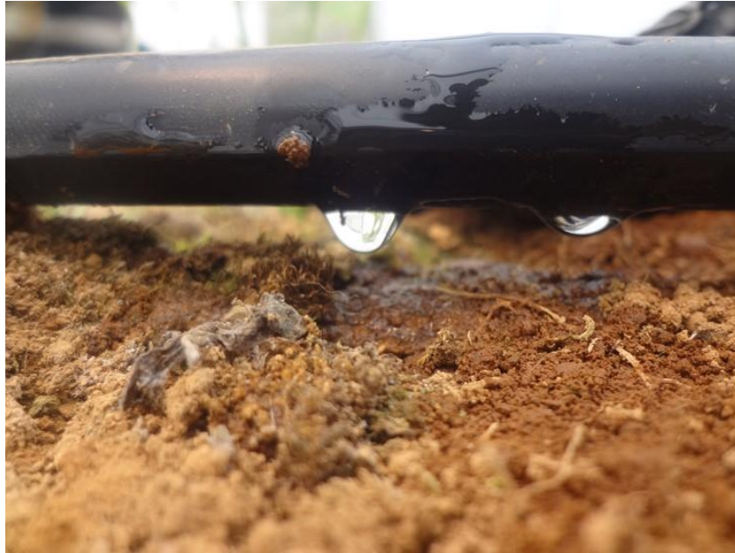
FIGURA 40. Prueba de las cintas de goteo para verificar la eficiencia de aplicación del riego.
