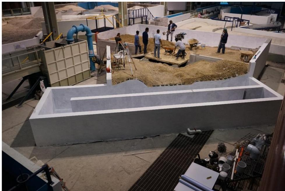
Figura 2-14. Preparación y colocación del material de relleno
