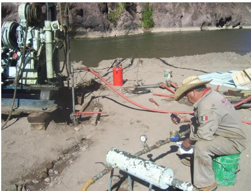
*Figura 4-2. Ensayes de Permeabilidad Tipo Lugeón en el macizo rocoso sobre el Eje Longitudinal de la Cortina para conocer las características Permeables del Conglomerado Baucarit que se tiene en la zona del cauce del Río Mayo. Fuente: Proyecto Ejecutivo de la Presa Reguladora Pilares, sobre el Río Mayo, Mpio. Álamos, Estado de Sonora. Capítulo IV. Geología.*
