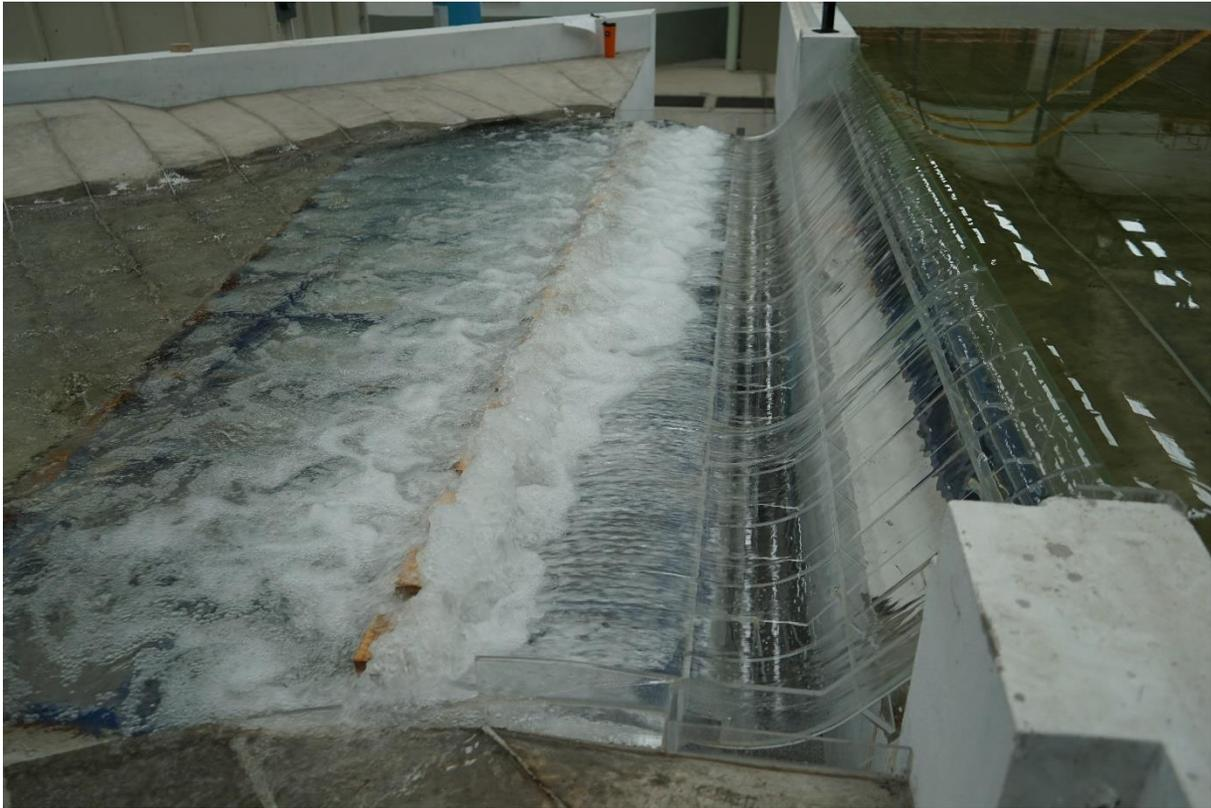
*Figura 2-21. Propuesta final en perfil de la obra de excedencias en prototipo*
