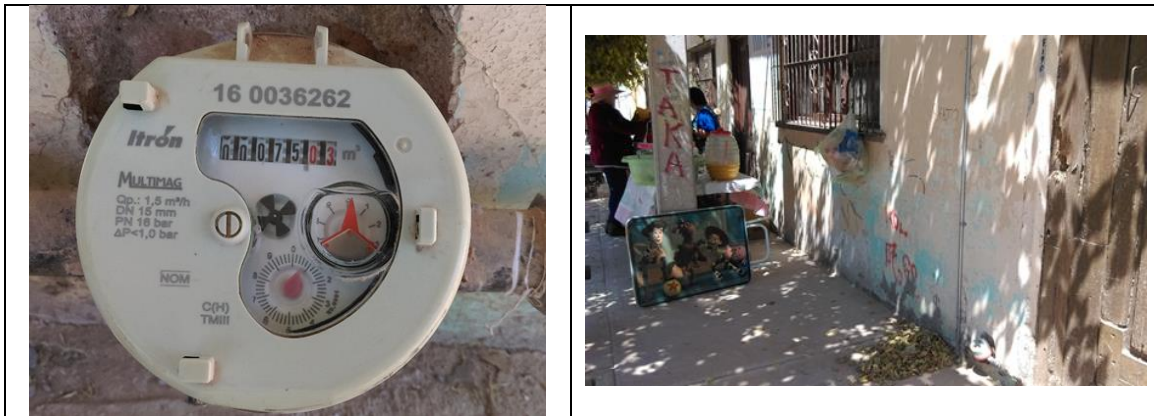
Figura 4. Medidor Itrón, Multimag 160036262, clase C, sin VAF. Detalles de medidor con número de serie. Colonia Centro Pte, municipio de Pedro Escobedo. Lectura del medidor: 75.03 m 3 . Se encontró que el medidor no tiene tapa, además debe corregirse la marca (es Itrón, no Itrón-Actaris) en el padrón de usuarios.
