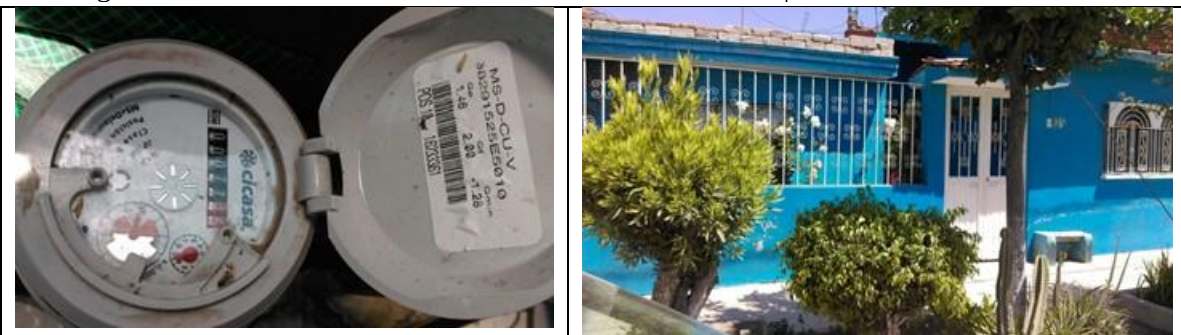
Figura 3. Medidor CICASA, MS Delaunet 16233361, clase B, sin VAF. Detalles de medidor con número de serie. Colonia Centro, municipio de Pedro Escobedo. Lectura del medidor: 77.324 m 3 . Se encontró que
