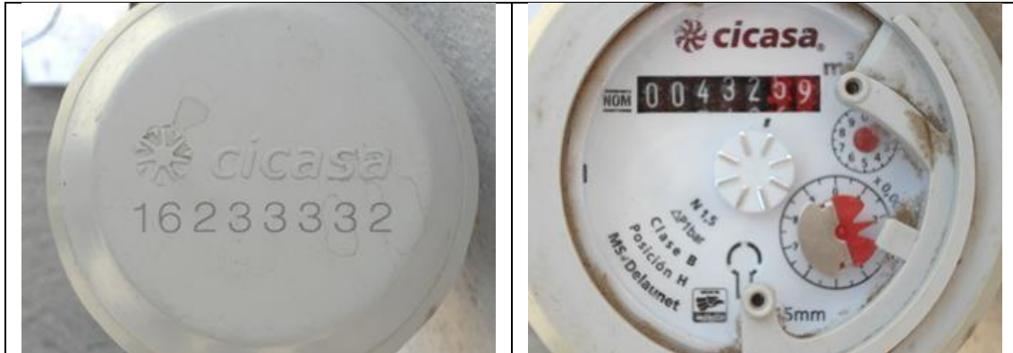
Figura 1. Medidor CICASA, MS Delaunet 16233332, clase B, sin VAF. Detalles de medidor con número de serie. Colonia Centro, municipio de Pedro Escobedo. Lectura del medidor: 432.59 m 3 . Se encontró que debe corregirse el modelo (es MS-Delaunet, no MMD-15-NG) en el padrón de usuarios. Atendió hija del usuario titular.
