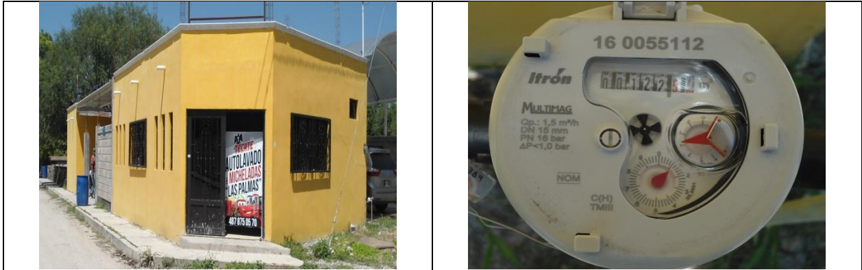
Figura 19. Medidor 160055112, clase C. Predio con toma y detalle de medidor con número de serie. Con VAF. Calle Andrés Balvanera S/N, localidad Arroyo Seco. Lectura del medidor: 122.57 m 3 . Se encontró que el modelo del medidor no corresponde al registrado en el padrón de usuarios de la CEA.
