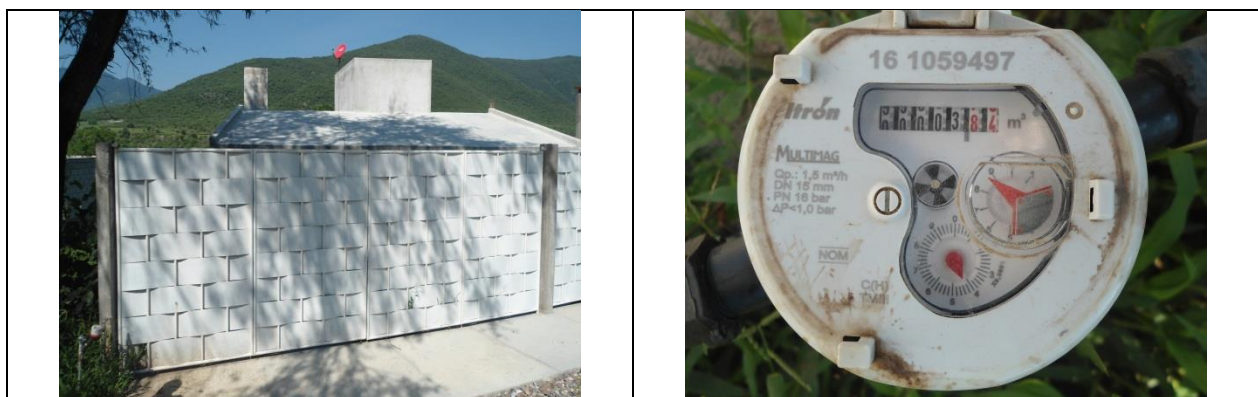
Figura 7. Medidor 161059497, clase C. Predio con toma y detalle de medidor con número de serie. Con VAF. Calle Miguel Hidalgo S/N, localidad San Isidro. Lectura del medidor: 3.84 m 3 . El número de medidor corresponde con el número proporcionado por la CEA, sin embargo la marca, modelo y características (clase) del medidor no corresponden a las registradas en el padrón de usuarios.
