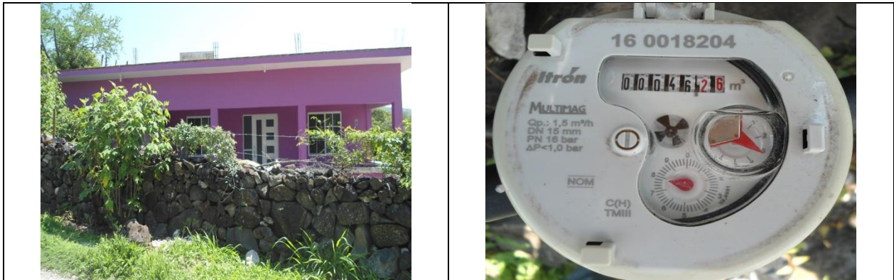
Figura 18. Medidor 160018204, clase C. Predio y detalle de medidor con número de serie. Con VAF. Priv. Benito Juárez S/N, localidad Arroyo Seco. Lectura del medidor: 46.26 m 3 . Se encontró que el modelo del medidor no corresponde al registrado en el padrón de usuarios de la CEA.
