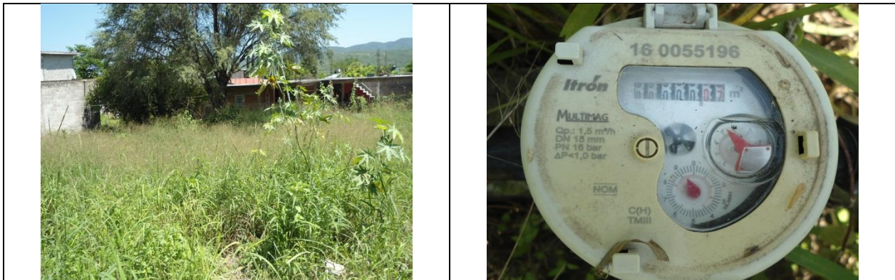
Figura 23. Medidor 160055196, clase C. Predio y detalle de medidor con número de serie. Sin VAF. Calle Vicente Guerrero S/N, col. Buenos Aires. Lectura del medidor: 0.06 m 3 .
