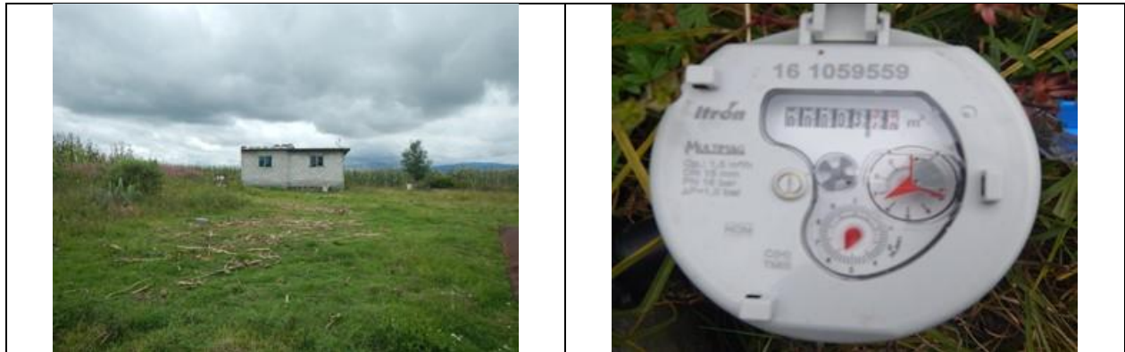
Figura 31. Medidor 161059559, clase C. Predio y detalle de medidor con número de serie. Sin VAF. Domicilio conocido, Barrio 6to., localidad Santiago Mexquititlán. Lectura de medidor: 3.39 m 3 .
