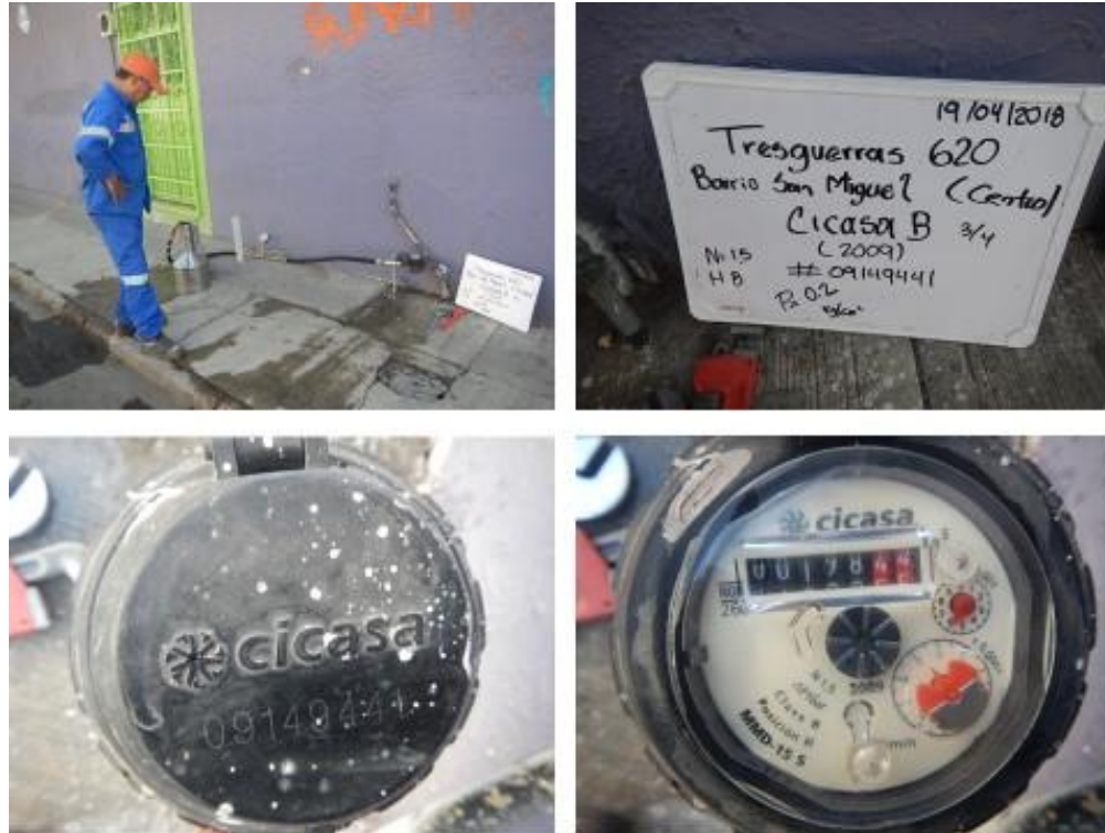
Ilustración 12. Pruebas de error de medición de flujo en tomas domiciliarias
