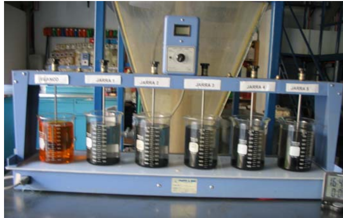
Figura 2. Prueba de jarras para coagulación-floculación.
