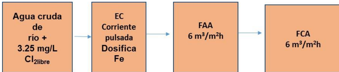
Figura 4-15 Tren de tratamiento por electrocoagulación y filtración para remover contaminantes emergentes.
