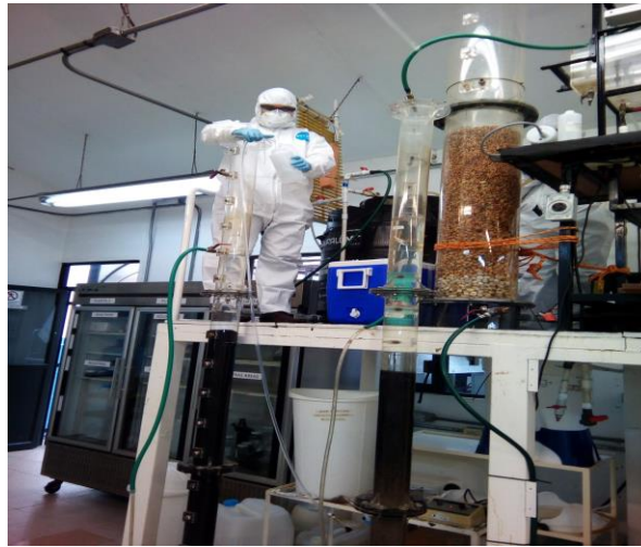
Figura 4-16 Toma de muestra después de la filtración en arena-antracita.
