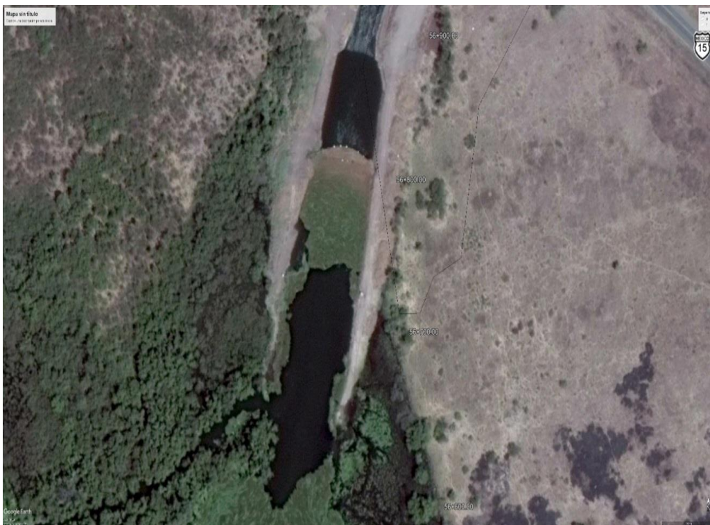
Figura 1.1.6 Taponamiento y “cuello de botella” que se forma en la salida del Dique Mariquita por efecto del taponamiento del lirio acuático.
