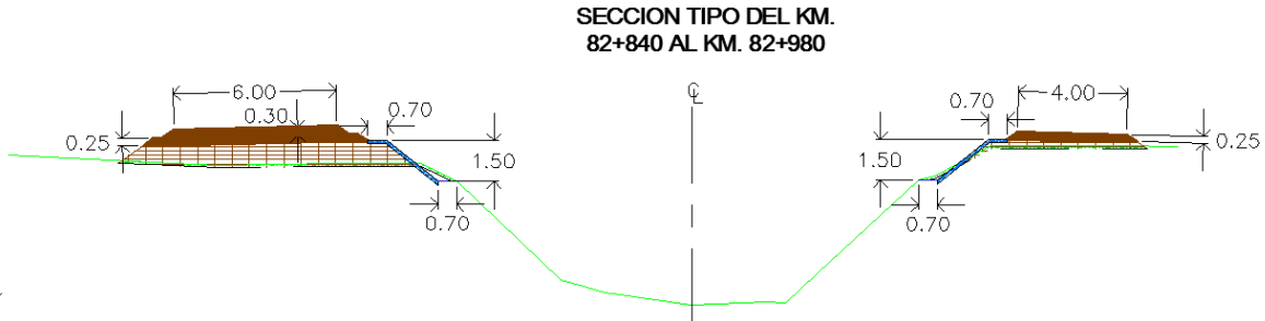
Figura 4.10 Sección de construcción en el primer tramo del km 82+840 al 83+040.
