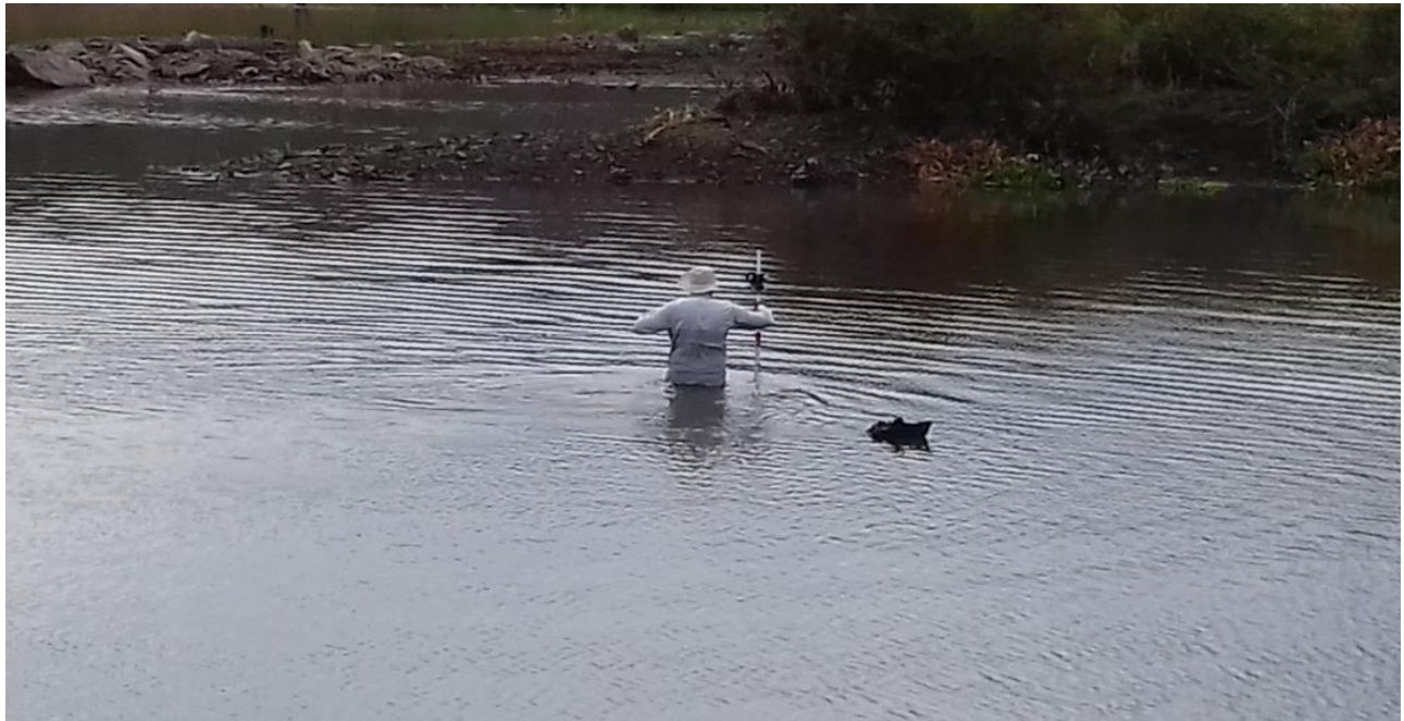
Figura 1.2.16 Levantamiento con equipo topográfico de alta precisión y coordenadas UTM a vadeo en la zona del lirio acuático.
