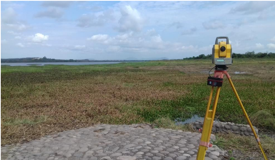
Figura 1.2.14 Levantamiento con equipo topográfico de alta precisión y coordenadas UTM.
