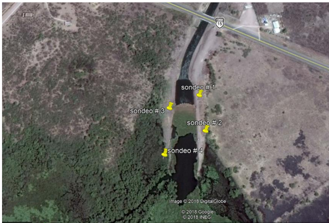
Figura 1.1.38 Ubicación de los sondeos de geotecnia realizados en la transición del Dique Mariquita.
