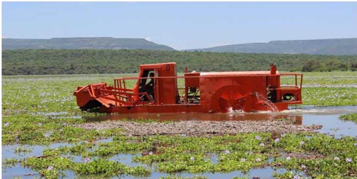
Figura 1.2.22 Triturador trabajando sobre lirio acuático en la Presa Julián Adame en Zacatecas.
