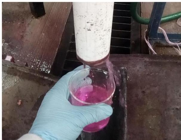
Figura 12 Toma de muestra de la rodamina B ( $C_{28}H_{31}ClN_2O_3$ )
