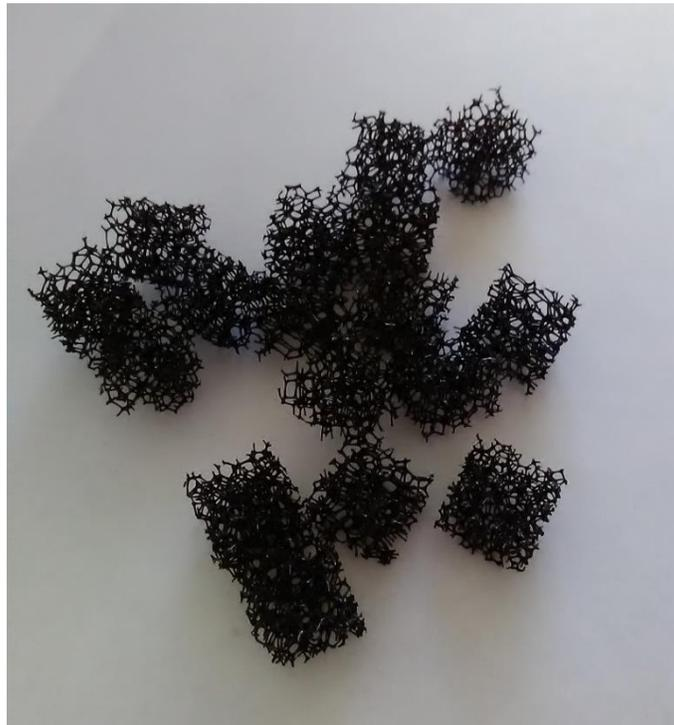
Figura 16. Cubos de poliuretano usados como medio de soporte para el crecimiento de la biomasa
