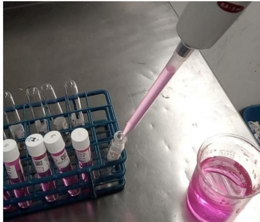
*Figura 13 Colocación de 10 mL de la muestra en viales para su lectura*
