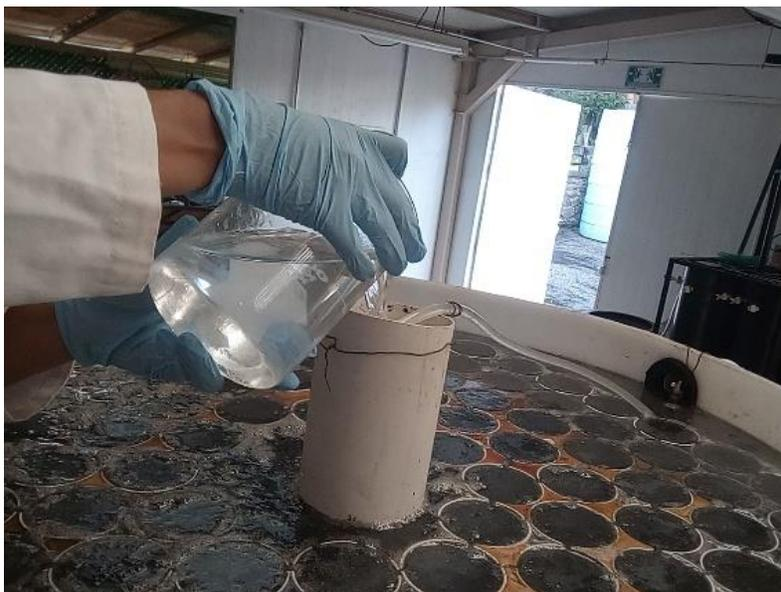
Figura 9 Vertido del cloruro de sodio (NaCl) en la entrada del sistema intradomiciliario
