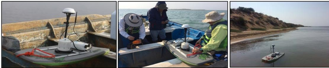
Figura 3.27 Medición con equipos CTD y Perfilador ADCP en laguna
