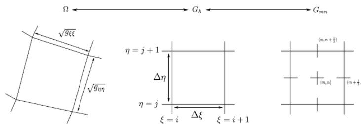
Figura 3.22 Mapeo del espacio físico al espacio Computacional (Discretización de la Malla) (Manual DELF3D)
