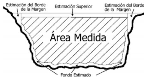
Figura 3.37 Fuente: grafico del área de medición del equipo (Manual River Surveyor M9 2009 )
