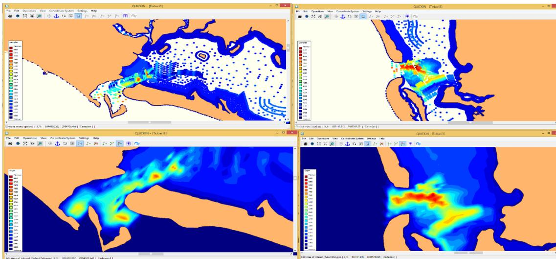
Figura 3.44 Interpolación de Batimetrías DELF3D
