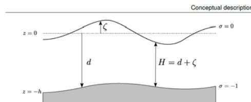
Figura 3.20 Definición del Nivel Aguas  $\zeta$ , Profundidad  $h$  y profundidad Total  $H$
