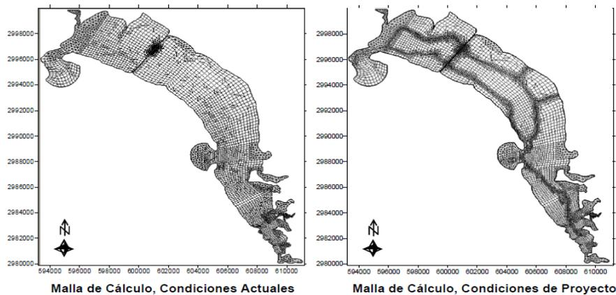
Figura 3.11. Malla de Análisis incluyendo dragados y pedraplén
