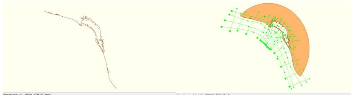
Figura 3.42 Línea de Costa en extensión .ldb para inicio de creación de malla (DEL3D)
