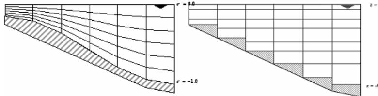
Figura 3.19 Esquema de la malla tipo  $\sigma$  (derecha) y malla tipo  $Z$  (izquierda), imagen de Manual Deltares (2013a)
