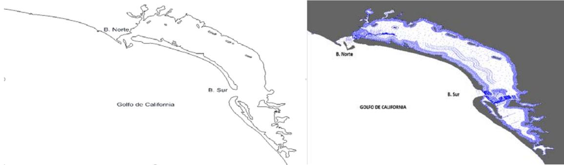
Figura 3.40 Línea de Costa Creada con CIVILCAD y ajuste de puntos con ayuda de puntos de control tomados en diferentes zonas durante las mediciones
