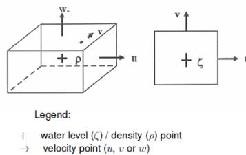
Figura 3.23 Escalonado de Malla, Vista 3D (izquierda) y Superior (Derecha), Manual DELF 3D
