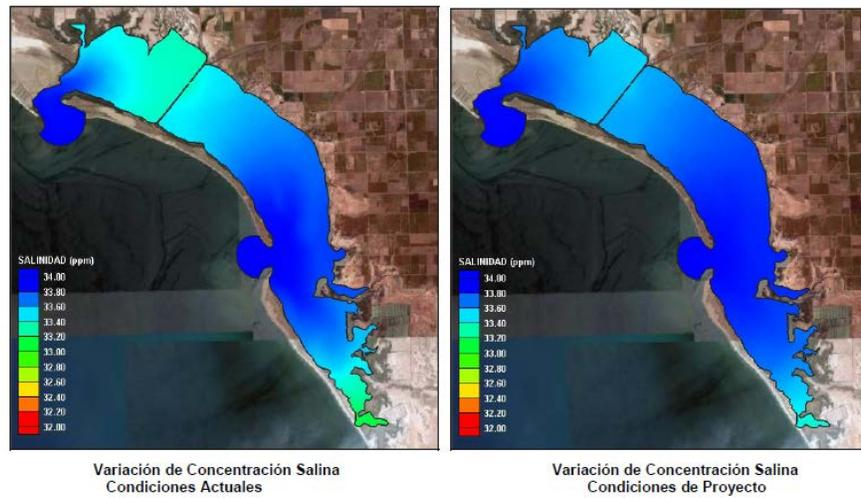
Figura 3.13 Simulación de Salinidad
