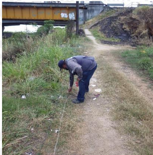
Figura 5.7. Instalación del tendido de geófonos en margen izquierda.
