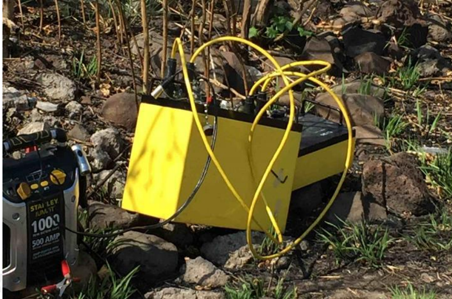
Figura 5.14. Equipo utilizado para la tomografía geoelectrica.
