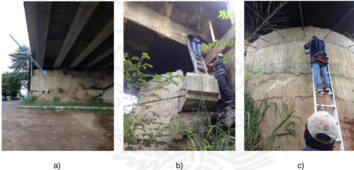
Figura 8.17. Inclinómetros colocados en a) el estribo de margen izquierda del puente La Pigua III, b) tablero del puente La Pigua II y c) estribo de margen derecha del puente La Pigua I.
