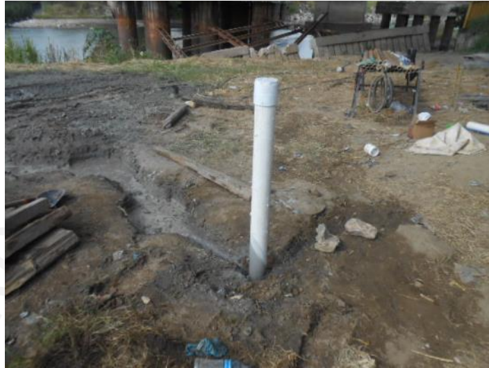
Figura 4.8. Sondeo adomado con PVC cédula 40.
