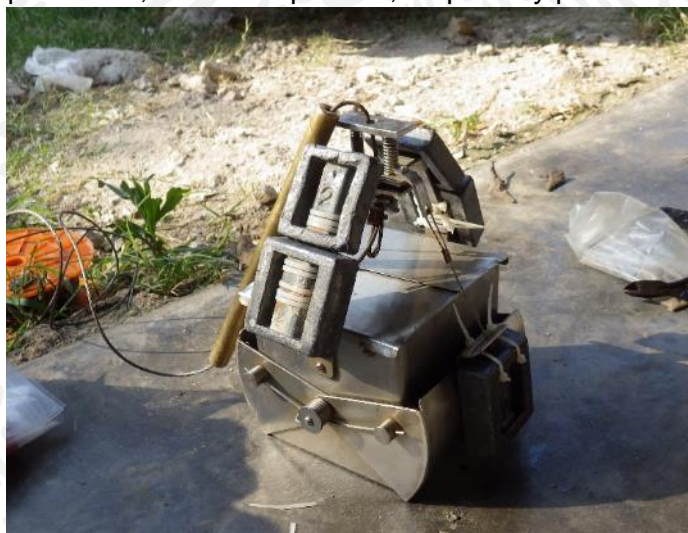
Figura 3.4. Draga tipo Ekman utilizada.
