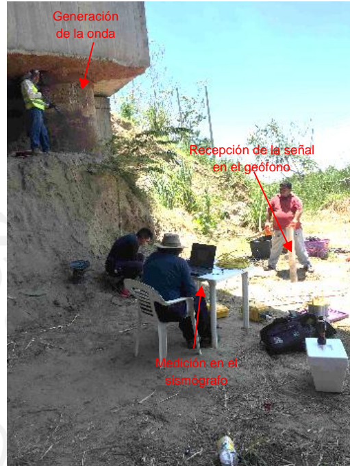
Figura 5.20. Configuración para la prospección sísmica DOWN-HOLE.
