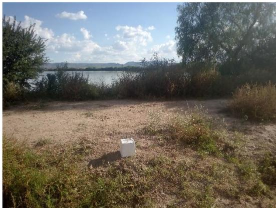
**Fotografía III.2 Vértice de referencia GPS1 en la ladera a la derecha de la presa Piedra Blanca.**
