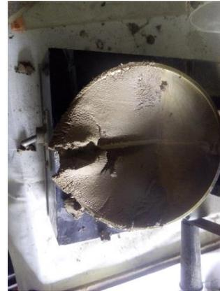
**Fotografía III.33 Prueba de límite líquido en copa de Casagrande.**
