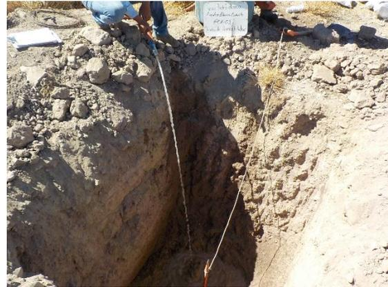
**Fotografía III.15 Prueba de permeabilidad en el PCA-2.**
