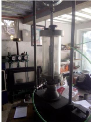
**Fotografía III.36 Prueba de compresión triaxial.**
