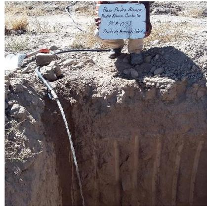
**Fotografía III.21** Prueba de permeabilidad en el PCA-4.
