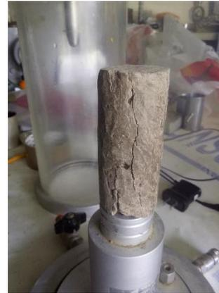
**Fotografía III.37 Probeta después de la prueba de compresión simple.**
