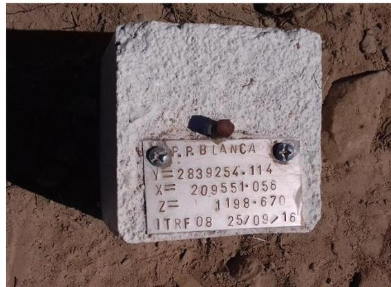
**Fotografía III.3 Coordenadas del vértice de referencia GPS1 en la presa Piedra Blanca.**
