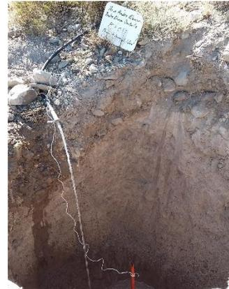
**Fotografía III.17 Prueba de permeabilidad en el PCA-3.**
