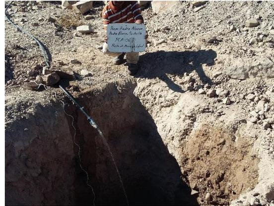
**Fotografía III.23** Prueba de permeabilidad en el PCA-6.
