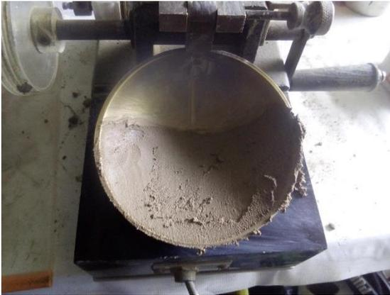
**Fotografía III.32 Prueba de límite líquido en copa de Casagrande.**
