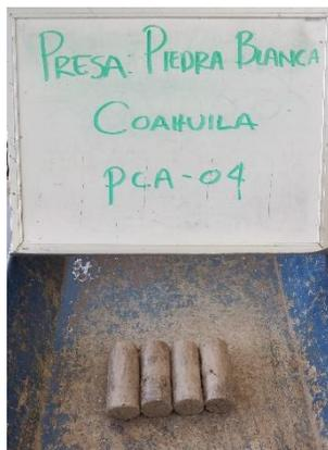
**Fotografía III.34 Probetas para prueba de compresión triaxial.**
