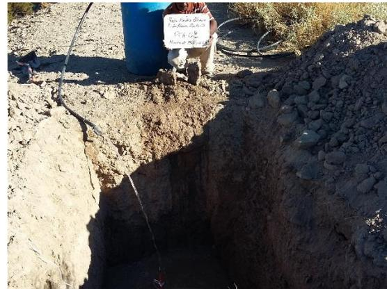
**Fotografía III.13 Prueba de permeabilidad en el PCA-1.**
