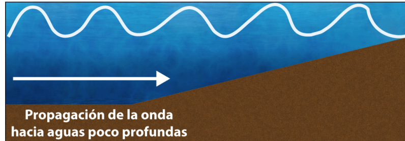
Figura 1.7: Deformación de la onda debido a la fricción del fondo oceánico propagándose hacia aguas poco profundas. Elaboración propia, adaptado de Pugh y Woodworth (2014)
