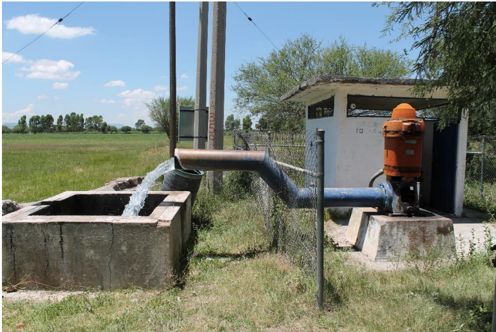
Figura A1.1. Medición de flujo por el método volumétrico.
