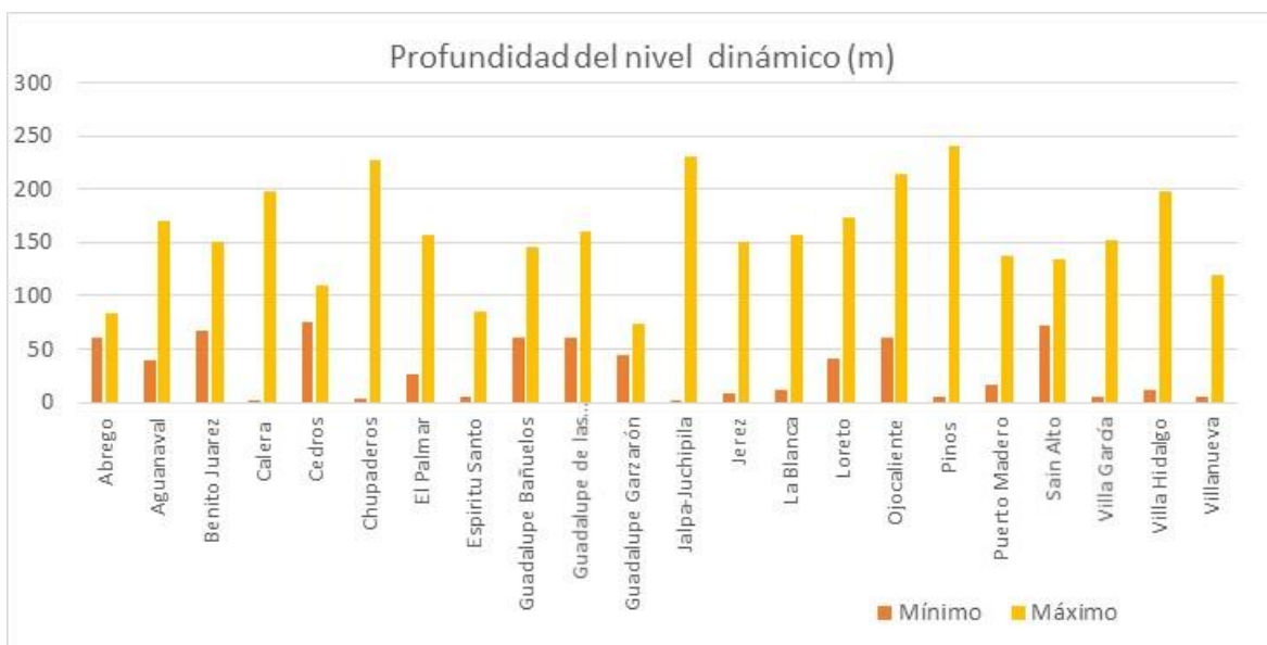
Figura 4.5. Niveles dinámicos en aprovechamientos modernizados
