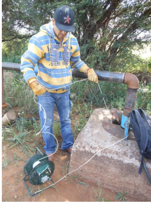
Figura 3.7 Sonda eléctrica para determinar nivel estático y dinámico
