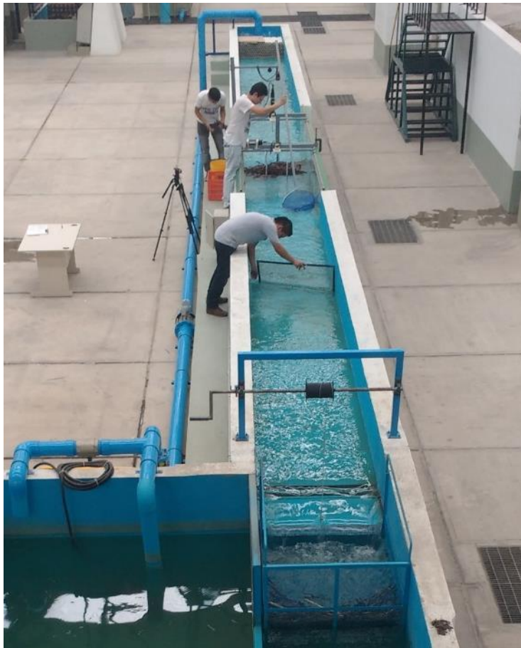
Figura IV-4 Retiro del material acumulado en las pilas, paso 7.
