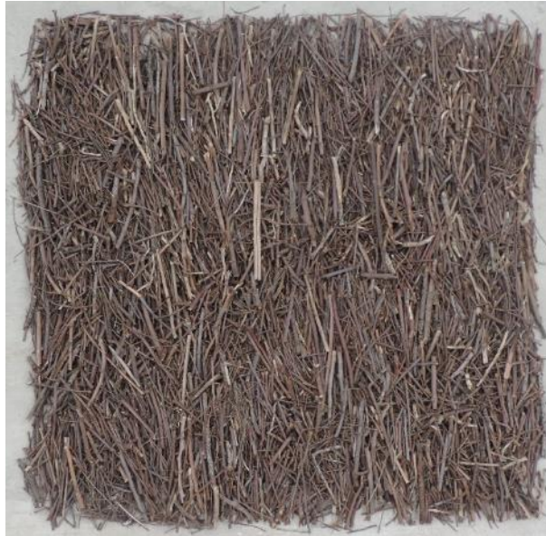
Figura III-24 Mezcla de material leñoso ( L_{\max} = 23.3 cm).
