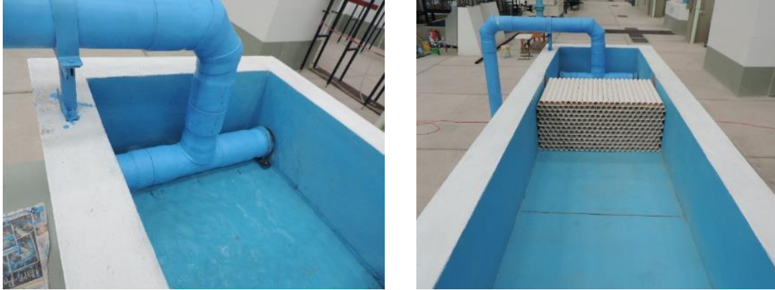
Figura III-6 Orientadores de flujo al inicio del canal.
