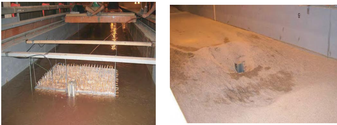
Figura I-43 Ensaye para una acumulación de troncos en forma rectangular. La imagen de la derecha muestra la configuración de la socavación para este tipo de modelo de troncos.
