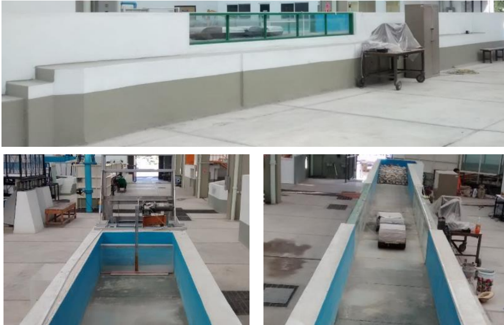
Figura III-2 Canal de olas (estado original del modelo).
