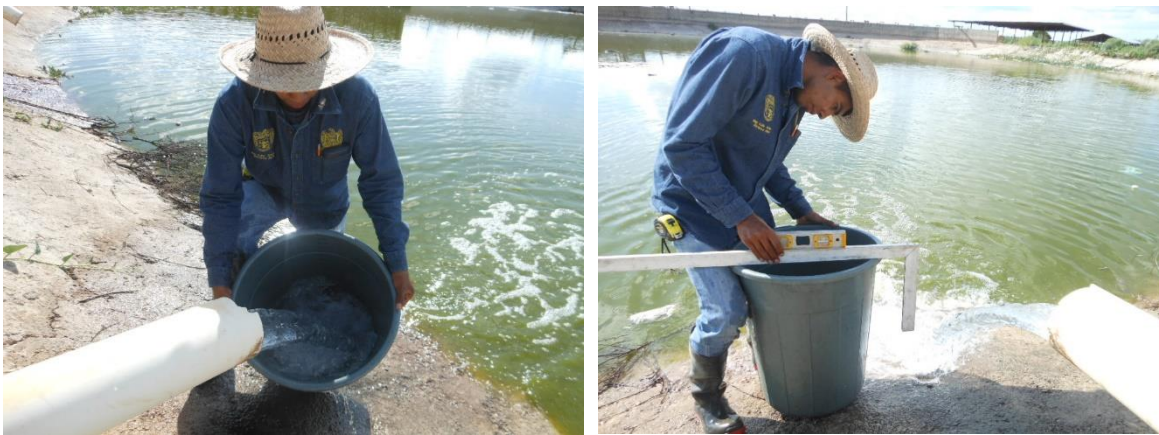
Figura 4.7 Aforo por el método directo
