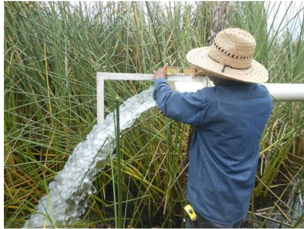
Figura 4.8 Aforo del gasto por el método de la escuadra
