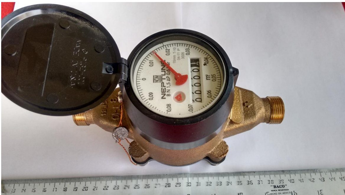
Ilustración 20 Medidor de agua tipo doméstico, marca Neptune, sin desarmar
