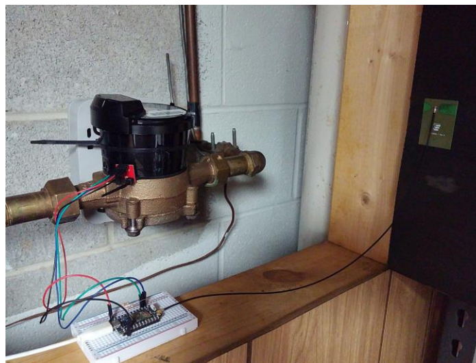
Ilustración 10 Interfaz WiFi para un medidor de agua, implementada con sensor Magnetometer Sparkfun y microcontrolador Sparkfun Photon
