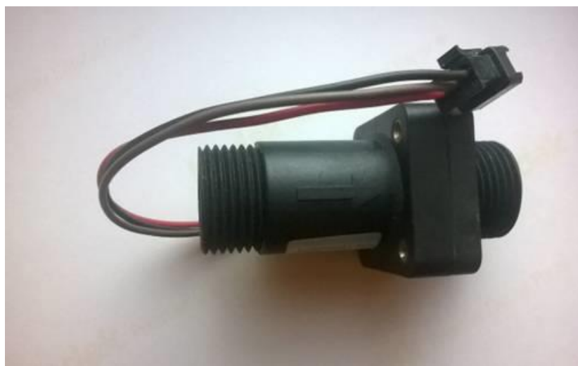
Ilustración 11 Sensor de flujo de media pulgada para aplicaciones IoT hecho de plástico
