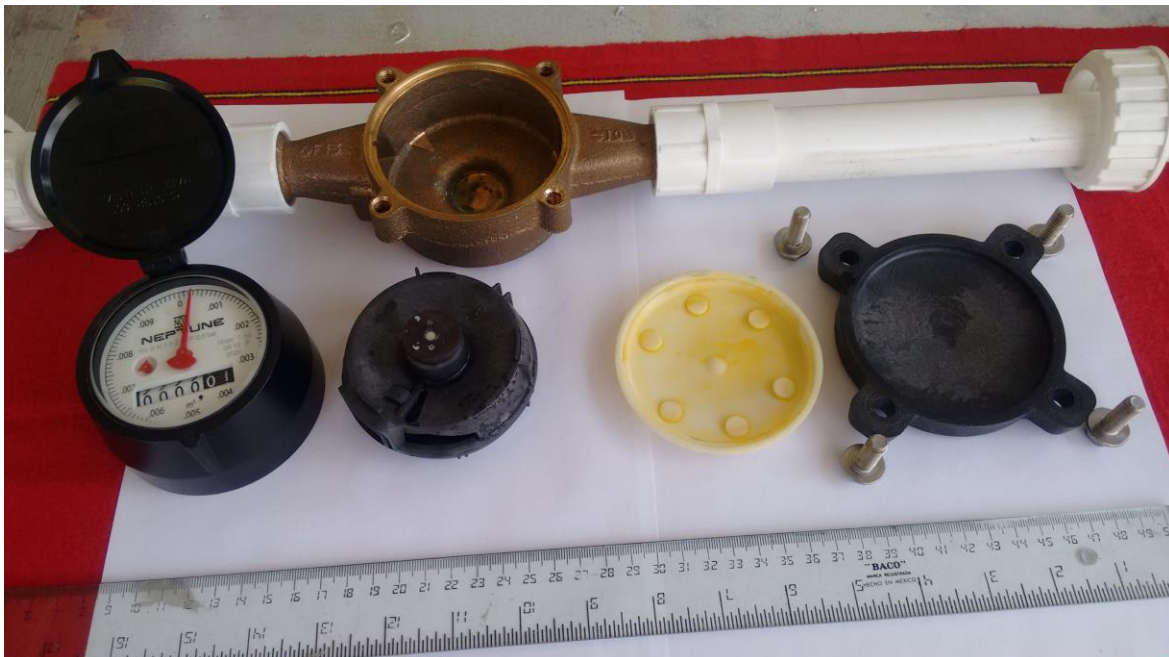
Ilustración 24 Medidor de agua tipo doméstico, marca Neptune, con cámara húmeda desarmada
