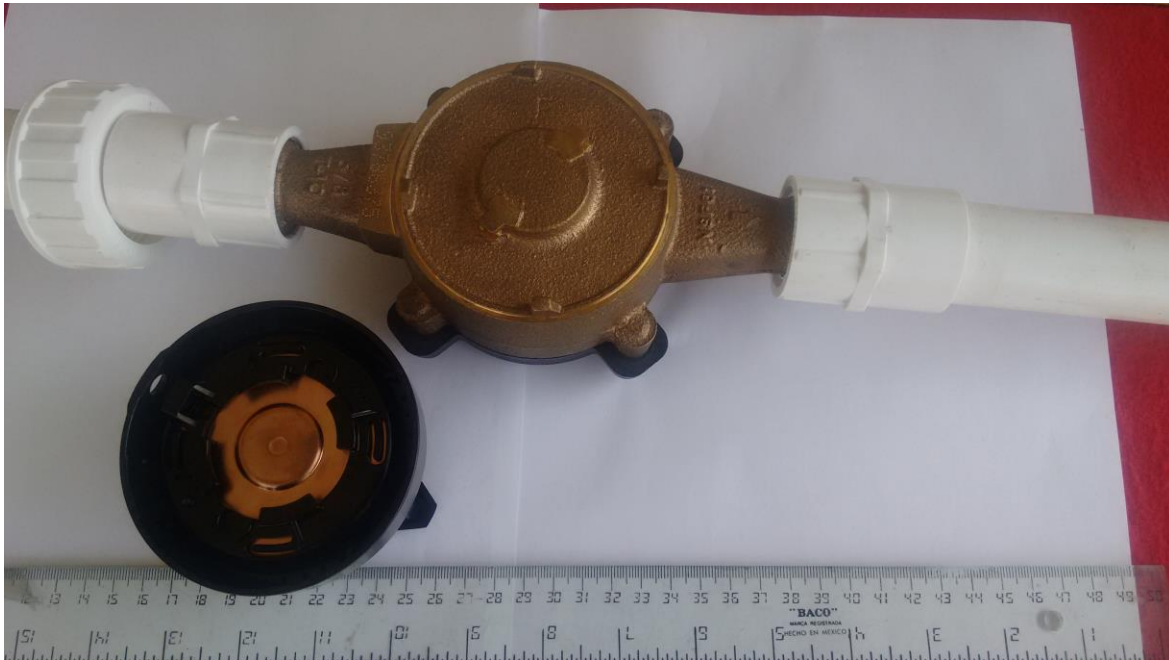
Ilustración 23 Medidor de agua doméstico, separado en cámara húmeda y cámara seca
