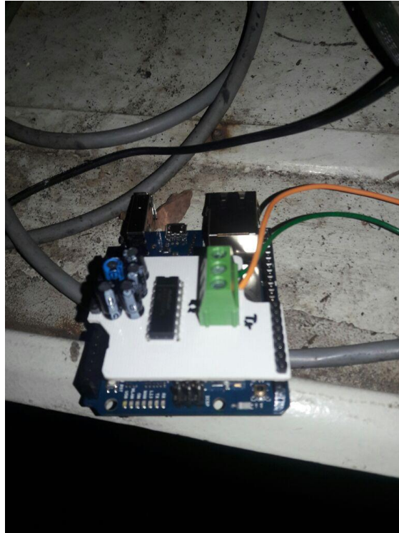
Ilustración 15 Arduino YUN con placa de conexión para pruebas en el Pozo IMTA
