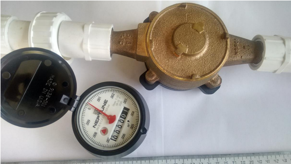
Ilustración 21 Medidor de agua tipo doméstico, marca Neptune, separado en dos partes: cámara húmeda y cámara seca
