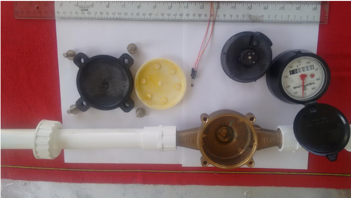
Ilustración 26 Medidor de agua tipo doméstico, marca Neptune, con cámara húmeda desarmada
