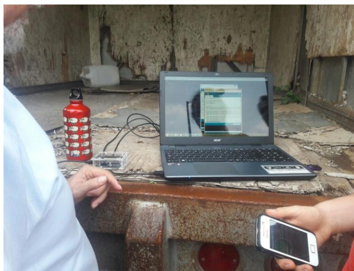
Ilustración 14 Programación del Arduino YUN y conexión a una red WiFi en el Pozo IMTA
