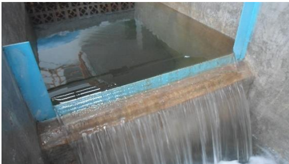
Ilustración 3.23. Medición del caudal de alimentación a las tuberías de prueba con flujo a superficie libre.
