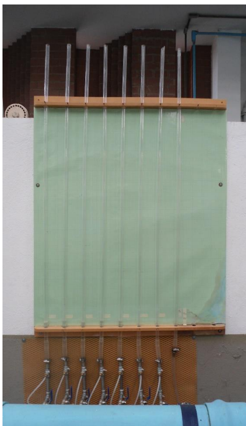
Ilustración 2.42. Tablero de tubos piezométricos instalados para pruebas en tuberías con flujo a superficie libre: vista general.
