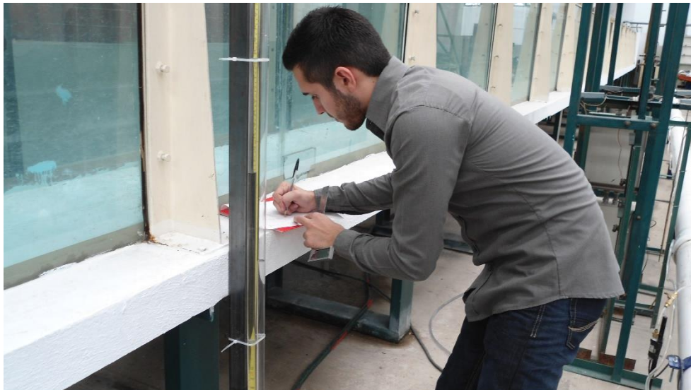
Ilustración 2.19. Toma de lectura de carga de presión durante una prueba en tubería de PVC.
