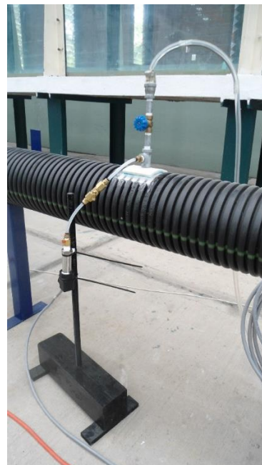
Ilustración 2.25. Tomas de cargas de presión en tubería de polietileno.
