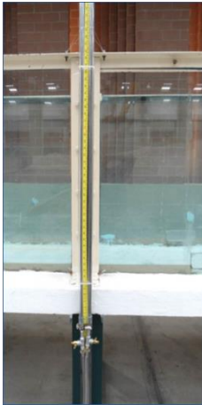
Ilustración 2.16. Tubos piezométricos: vista general
