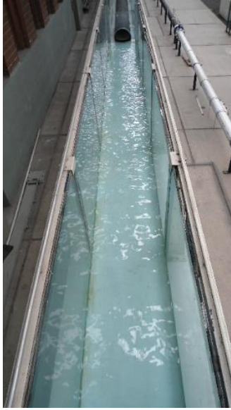
Ilustración 3.25. Vista del tramo aguas arriba de la alimentación a la tubería de prueba, dentro del canal de pendiente nula.
