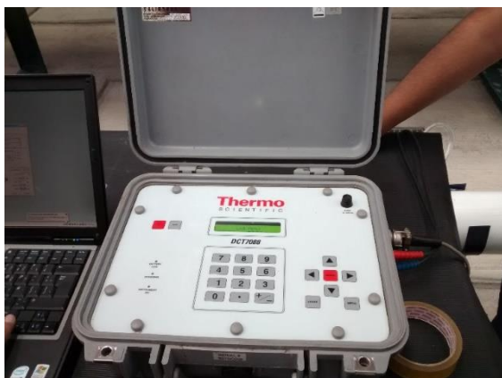
Ilustración 2.14. Medidor ultrasónico de tiempo en tránsito: vista general del equipo.
