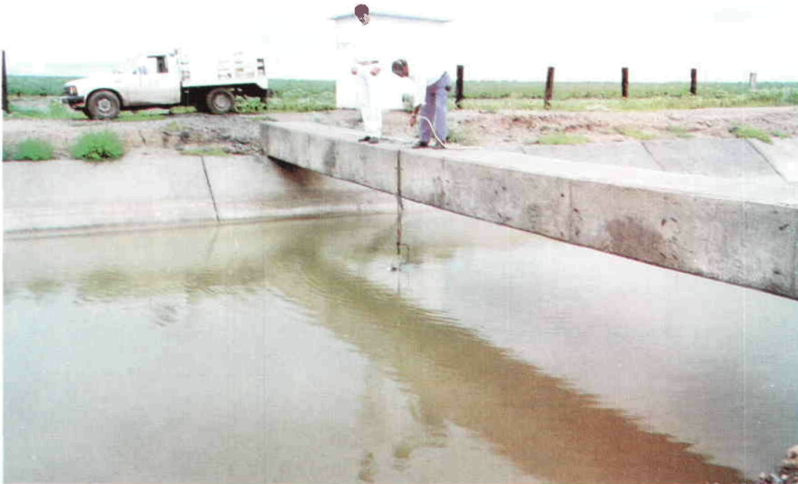
Ubicación del molinete para medir velocidad a seis décimos de profundidad.
