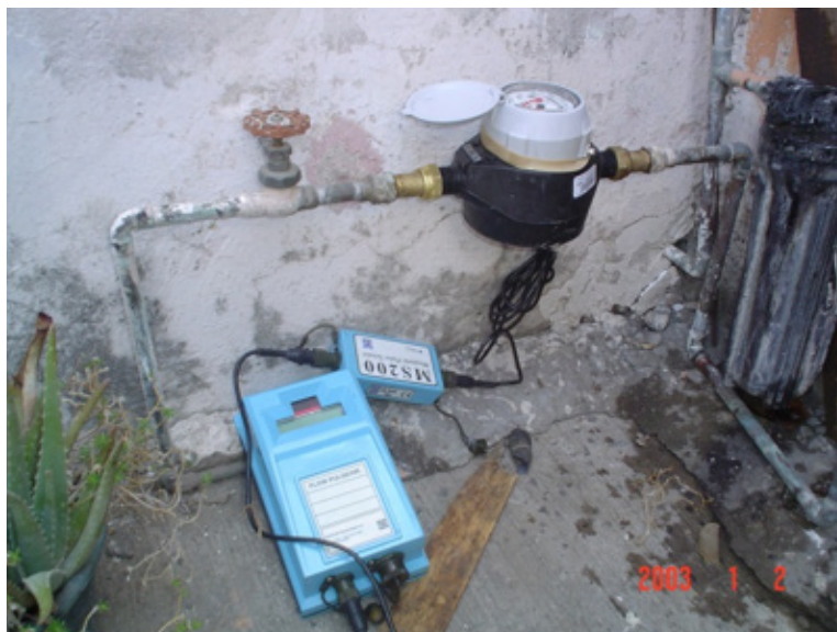
Figura 3.1.3. Arreglo de medición usado, compuesto de micromedidor, sensor magnético de pulsos y registrador.
