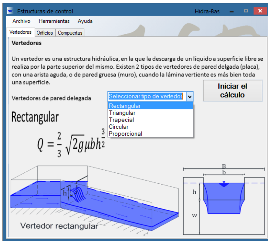
Ilustración 10.36 Estructuras de control, vertedores, conceptos.
