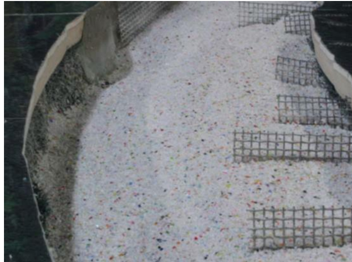
Figura 11. Diques de malla de alambre galvanizado en modelo HSR.
