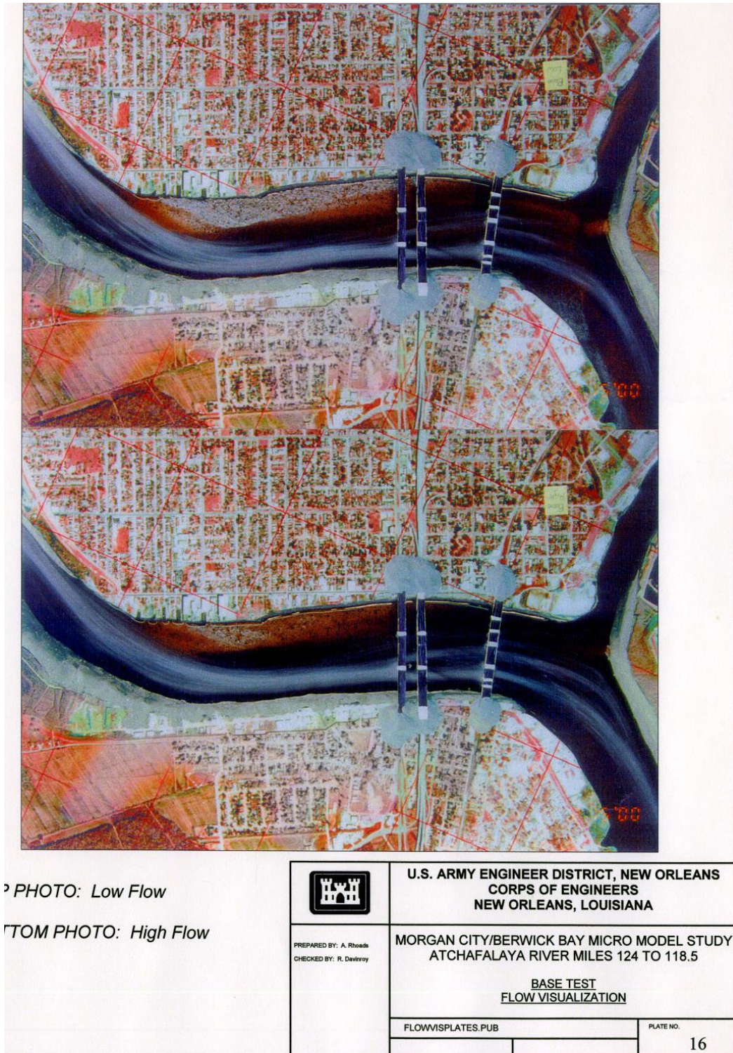
Figura 25. Visualización de Flujo en la prueba Base, Estudio en micro modelo del Río Atchafalaya. En la parte superior se muestran flujos bajos y en la parte inferior para flujos altos.
