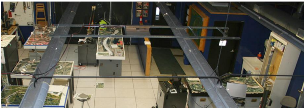
Figura 30. Micromodelos de tramos de ríos de EUA
