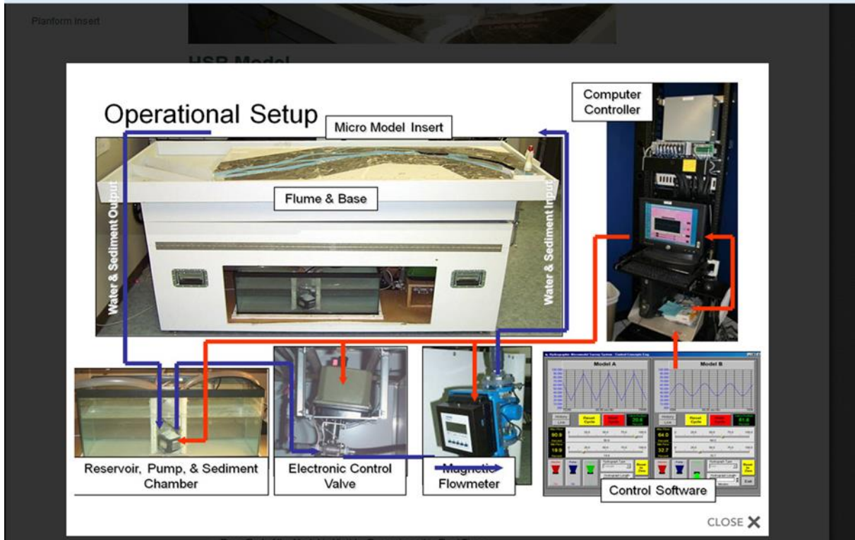
Figura 1. Micromodelo y algunos equipos medidores de flujo y válvulas electrónicas.
