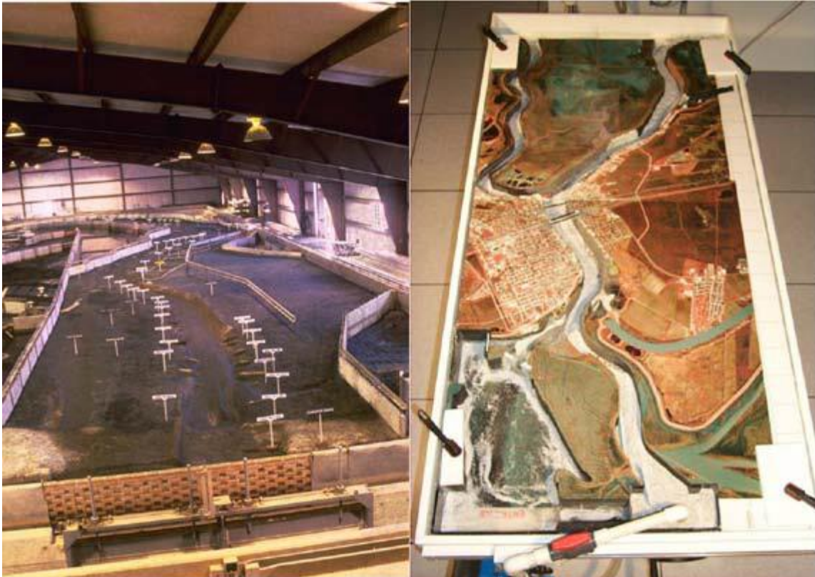
Figura 8. Modelo de fondo móvil de carbón, Curva en Dogtooth, escala 1:400 horizontal, 1:100 vertical, and (b) modelo HSR, Río Atchafalaya, escala 1:7200 Horizontal, 1:1200 Vertical
