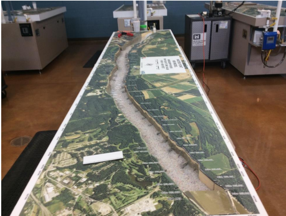
Figura 31. Micromodelo del Río Misisipi, las obras de protección se observan en la margen derecha.
