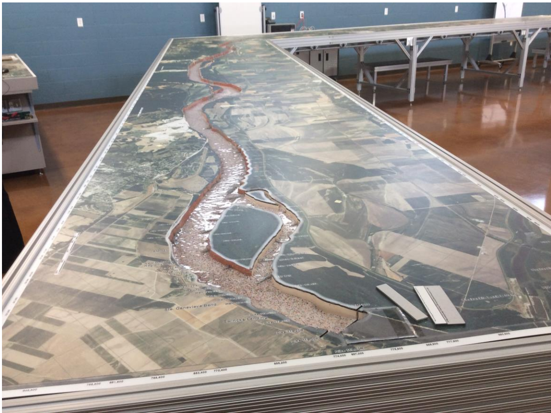
Figura 32. Micromodelo del río Mississippi donde se observa una gran isla y las obras de protección
