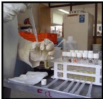
Fig. 4.7 Transferencia de volumen del vial de digestión a la celda de cuarzo
