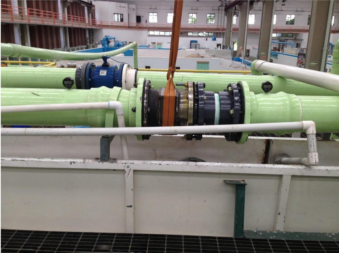
*Ilustración 4.4 Pruebas hidráulicas para determinar la pérdida de carga del dispositivo magnético*
