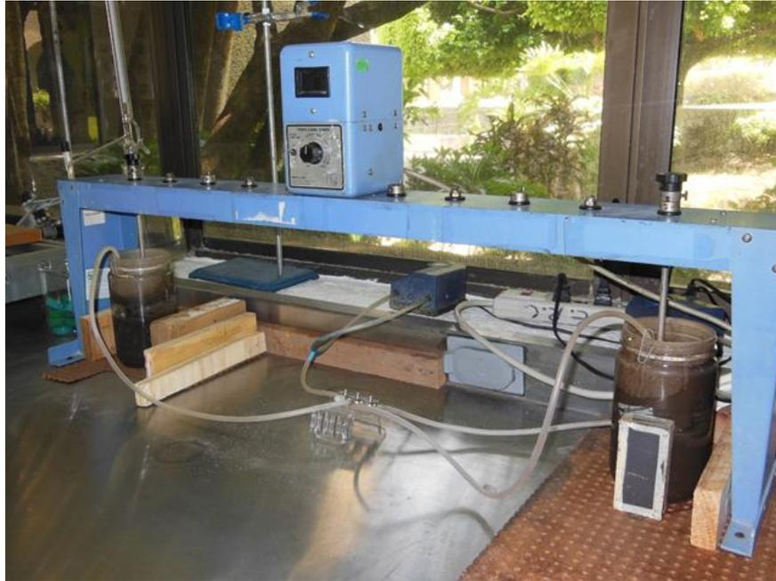
*Ilustración 5.2 Reactores blanco (sin imanes, izquierda) y con 150 Gauss de intensidad de campo magnético (derecha)*
