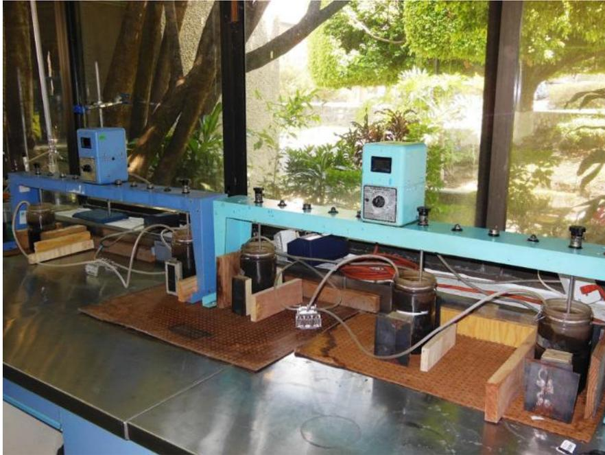
*Ilustración 5.3 Reactores experimentales. Se observa el sistema de inyección de aire y los agitadores, la separación con maderas para evitar influencia de campo magnético.*
