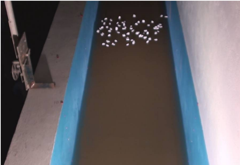
Figura 4.9 Siembra con poliestireno extendido.
