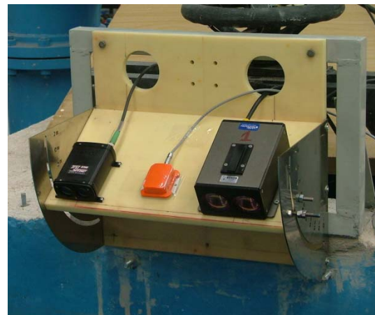
Fotografía 2. Soporte inclinado con tres instrumentos: (izq.) distanciómetro láser "TruSense S200", (centro) inclinómetro "MTi" y (der.) distanciómetro láser "ULS".
