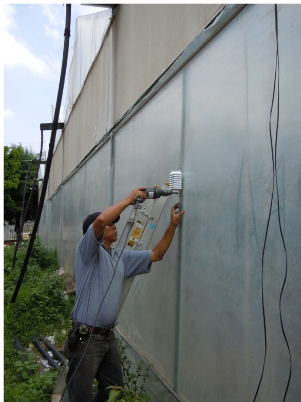
Ilustración 1.15. Sensores de Temperatura y Humedad relativa afuera del invernadero.
