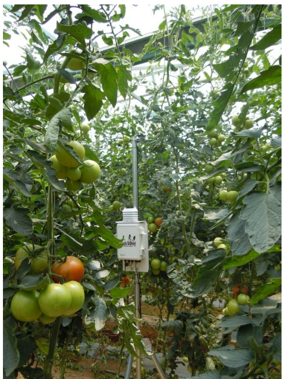
Ilustración 1.12. Caja de instrumentación y sensores de Temperatura y Humedad relativa dentro del invernadero.
