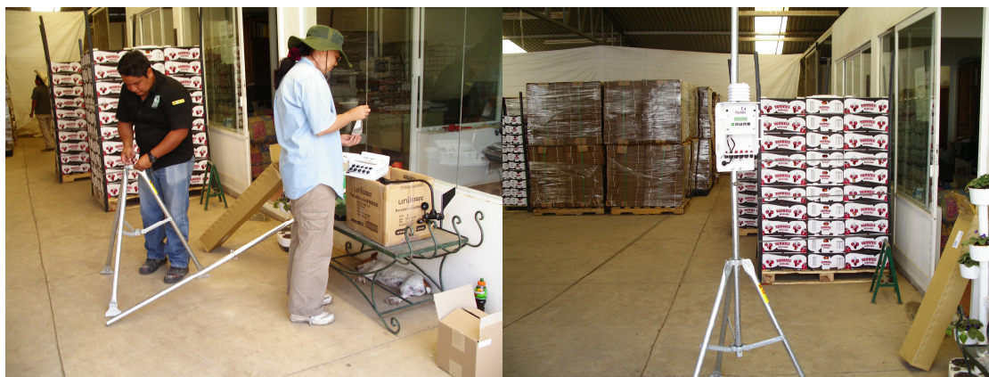
Ilustración 1.8. y 1.9. Armado de la estructura de la estación meteorológica.
