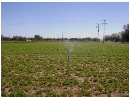
Ilustración 5.72. Sistema de aspersión portátil manual evaluado.
