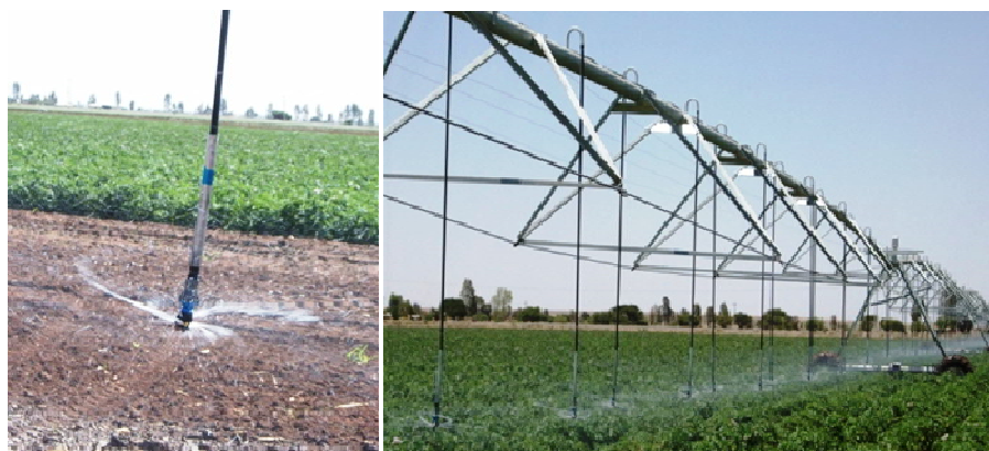
Ilustración 5.53. Microaspersor y tubería regante de avance frontal.
