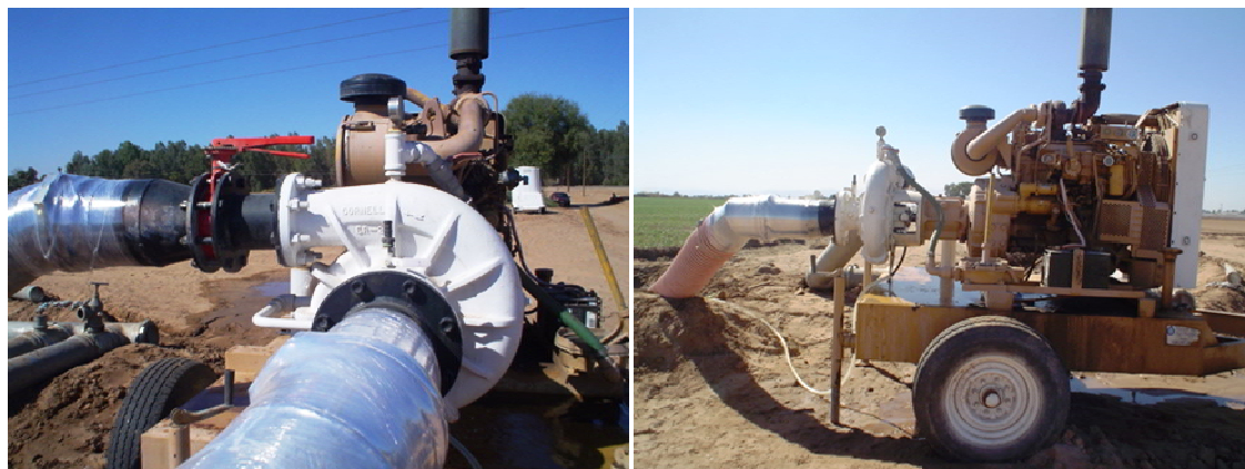
Ilustración 5.33. Motobomba centrífuga diesel remolcable.
