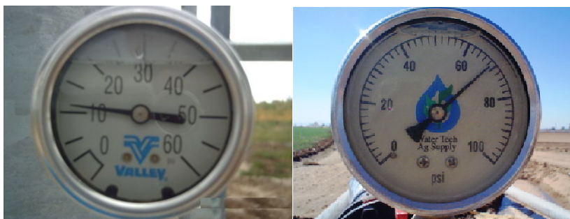
Ilustración 5.22. Manómetros con glicerina (reductora de vibraciones).
