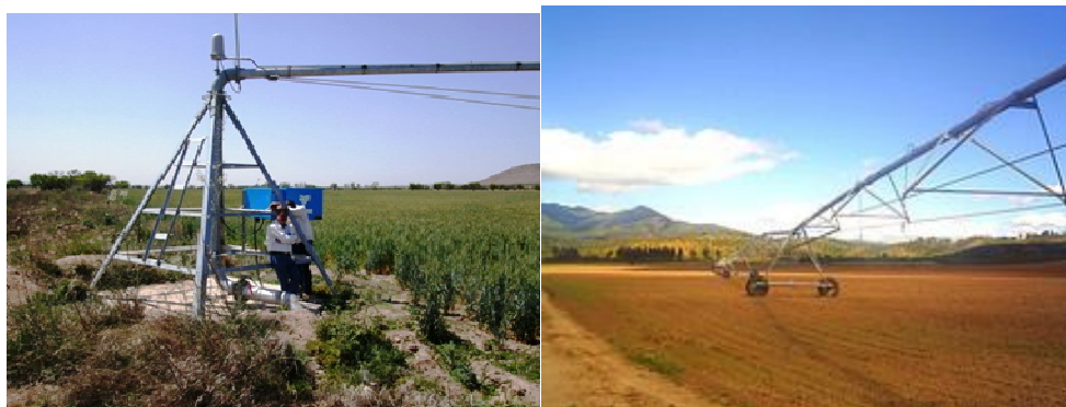
Ilustración 5.50. Sistemas de riego con pivote central para permitir el giro de la tubería regante.
