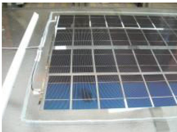
Figura III.20 Colocación de silicón transparente en las orillas del panel.
