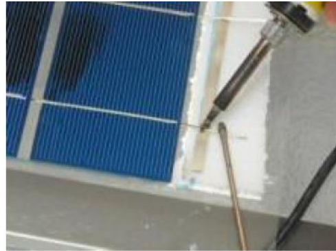
Figura III.18 Proceso de soldado entre celdas
