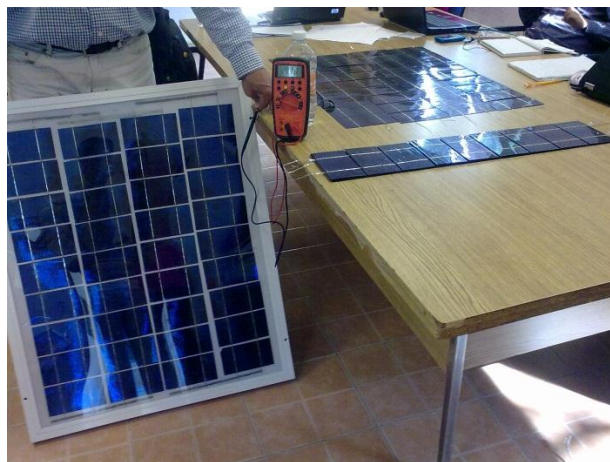
Figura III.22 Prueba de funcionamiento del panel.
