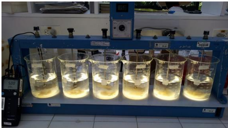
Figura 4.9 Pruebas para determinar la disolución de LEC en función del pH del agua
