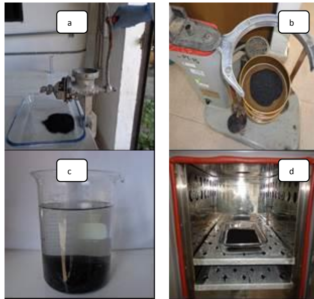
Figura 4.2. Preparación del carbón de hueso para ser colocado en minicolumnas a) molienda, b) tamizado, c) lavado con agua desionizada y d) secado a 100°C
