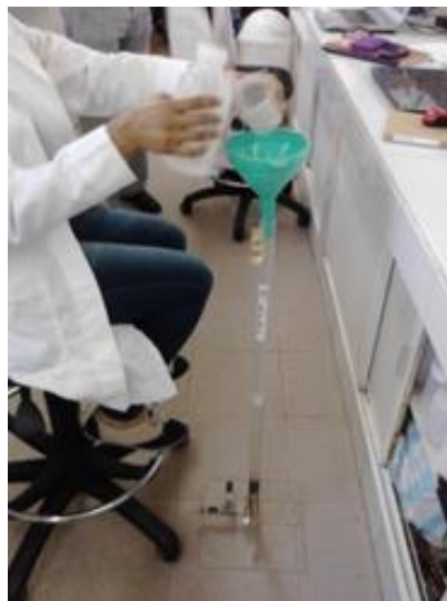
Figura 4.3. Empaque del carbón de hueso en las minicolumnas.
