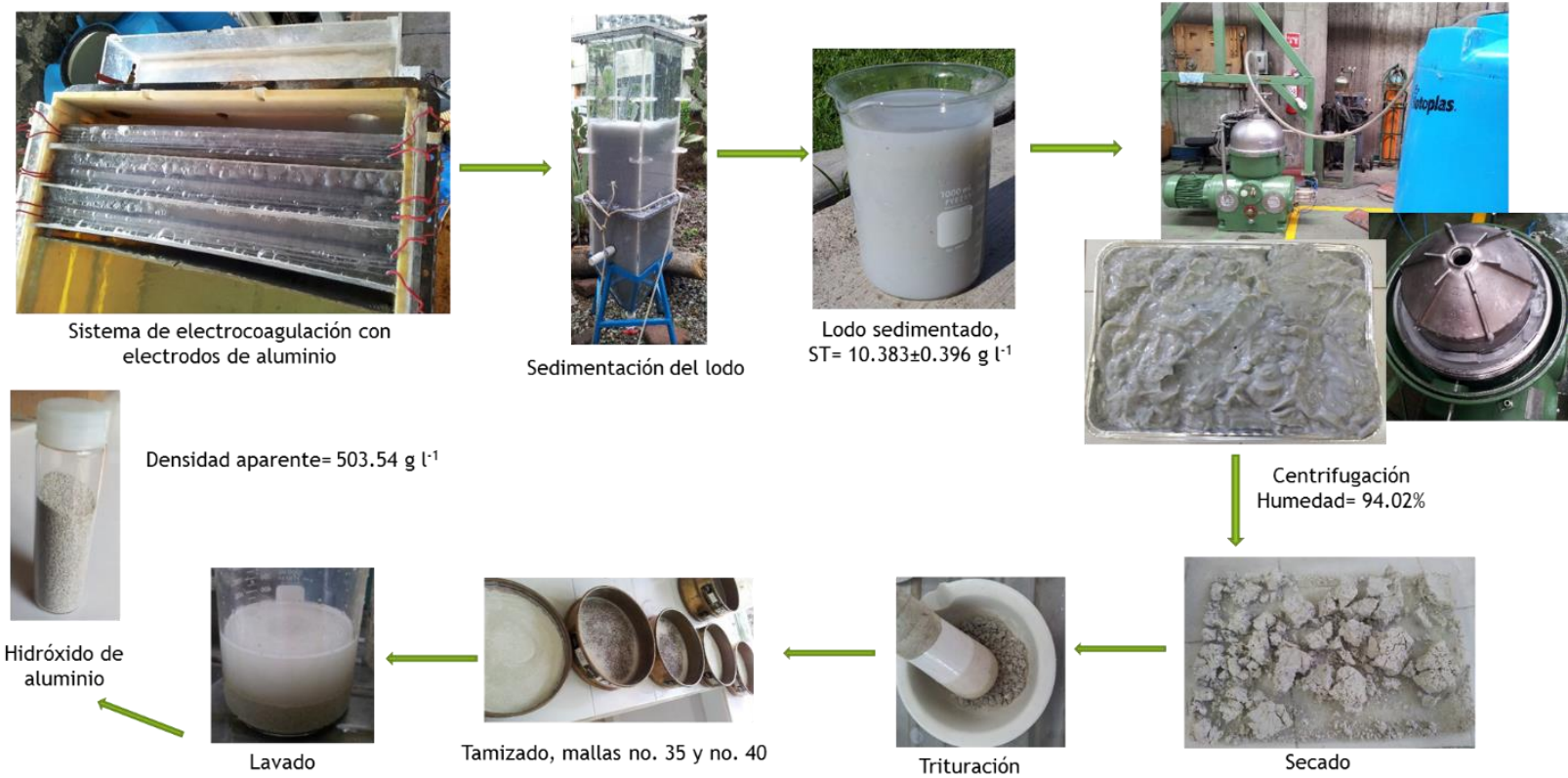
Figura 4.8 Representación gráfica del proceso de generación de lodos de aluminio a partir de oxidación electrolítica
