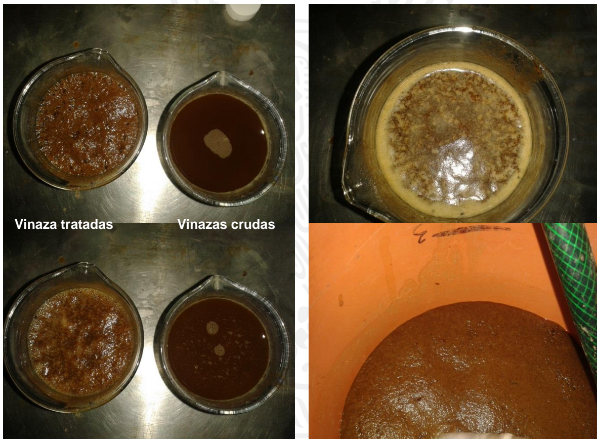
Figura 4.12. Característica física de la vinaza tratada mediante fotólisis UV con adición de H_2O_2
