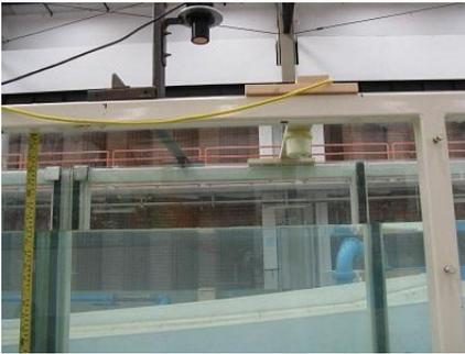
Ilustración 5.3 sensores ultrasónicos del UTG- 21DS, SOLO-IMTA y cinta de referencia.
