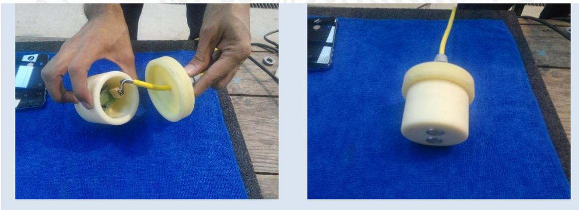
Imagen 5.9 Sensor ultrasonico armado
