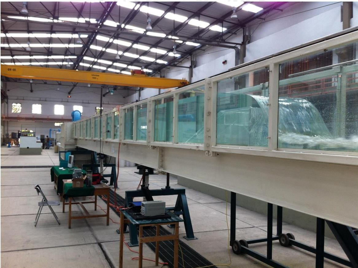
Imagen 5.42 Prueba en canal del gasto medido
