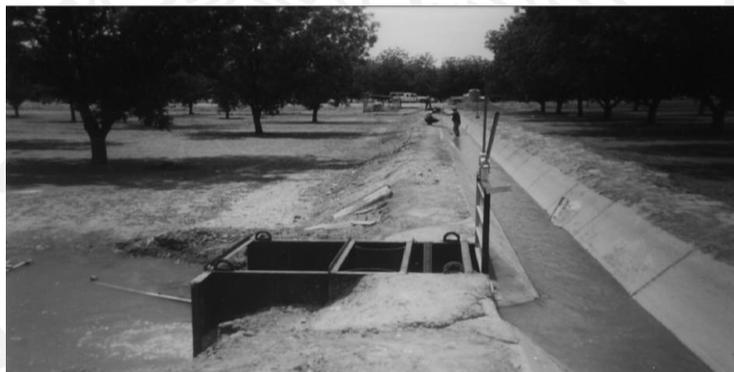
Figura 1.16 canal instalado en una acequia
