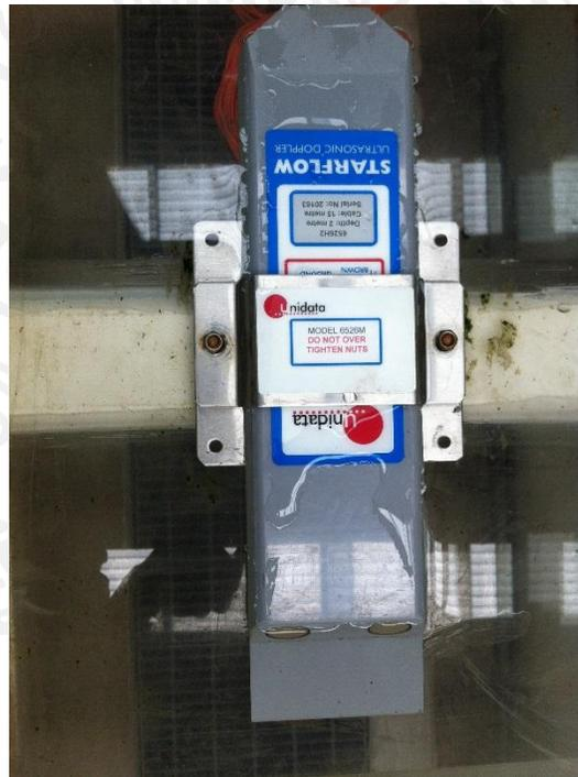
Imagen 5.45 Sensor de Medidor de nivel
