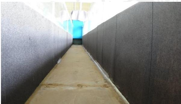
**Fotografía 5. Canal recubierto de lija**
