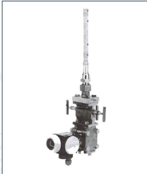
Figura 1.25 Tubo de Pitot se observa claramente las tomas de presión (arriba), el colector (centro) y el transmisor de presión (abajo).
