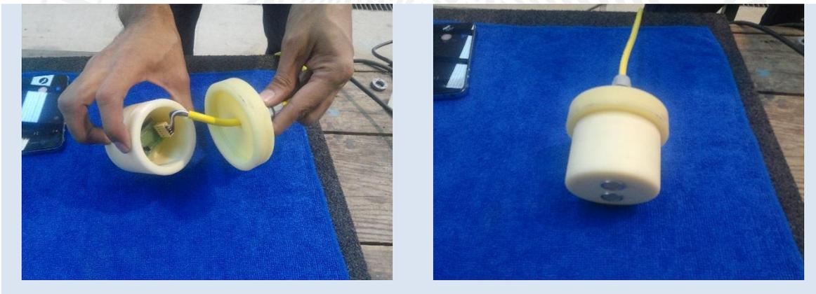
Imagen 5.21 Armado final de sensor ultrasonico
