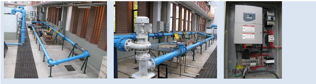
Imagen 2.1 Circuito de prueba usado, bomba y variador de velocidad
