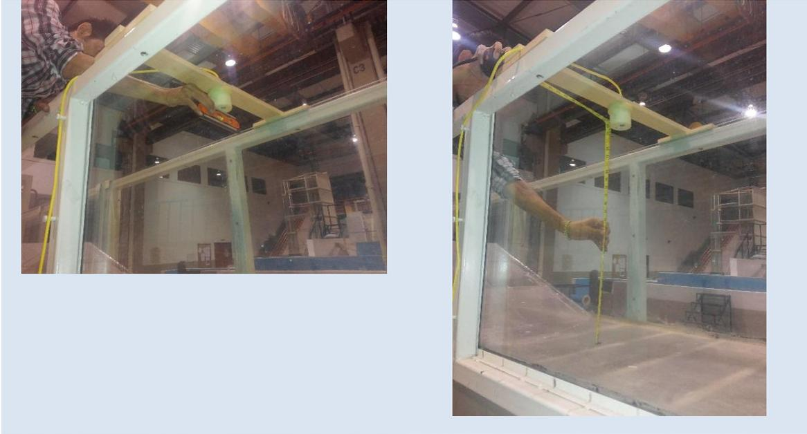
Imagen 5.39 Nivelación del sensor ultrasónico
