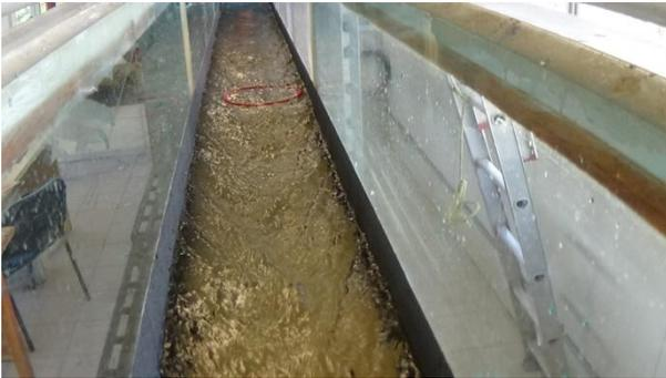
**Fotografía 6. Trazador sobre la superficie del canal**
