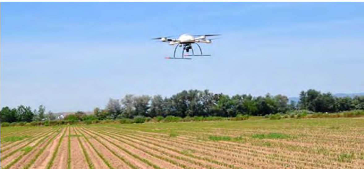
Figura 4.4 Detalle de un VANT equipada con cámaras espectrales para monitoreo del estado hídrico de parcela ( https://adalidda.com/en/jobs/agricultural-drones-jobs ).
