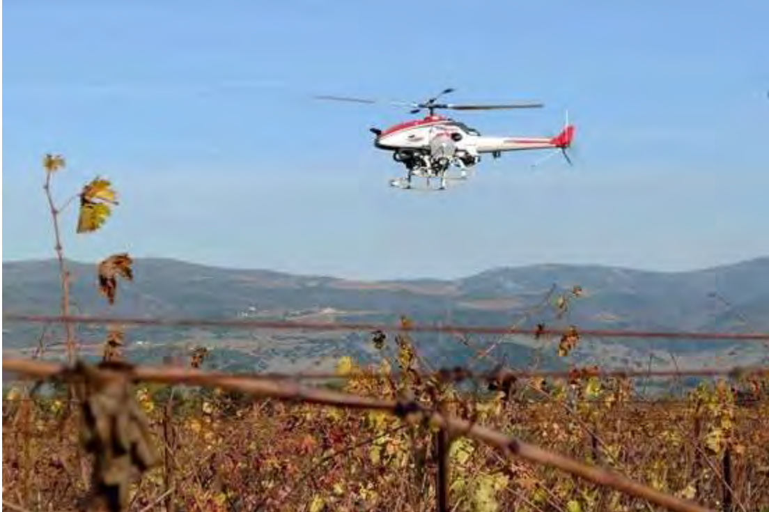
Figura 3.21 VANT capaz de rociar pesticidas sobre un viñedo (KenGiles/UC Davis) [King, R. 2013].
