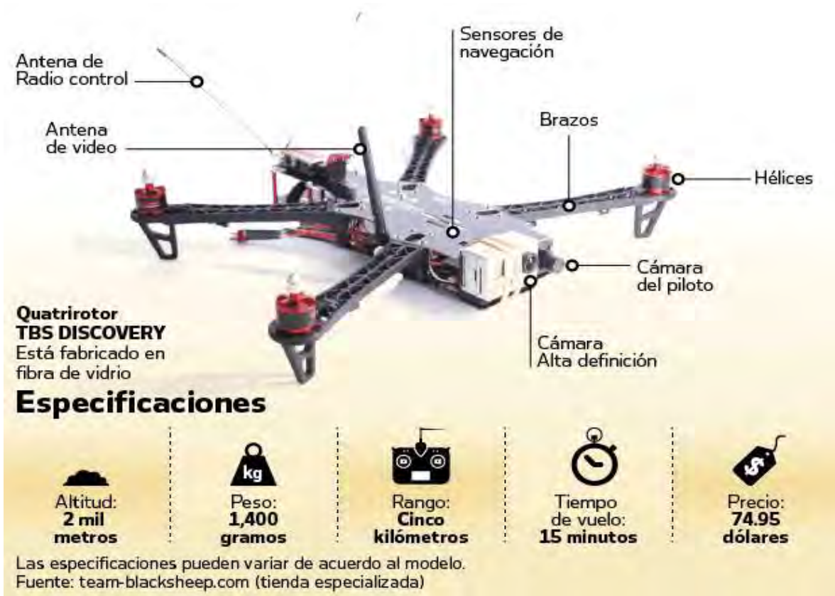
Figura 5.9 Componentes básicos de un VANT.
